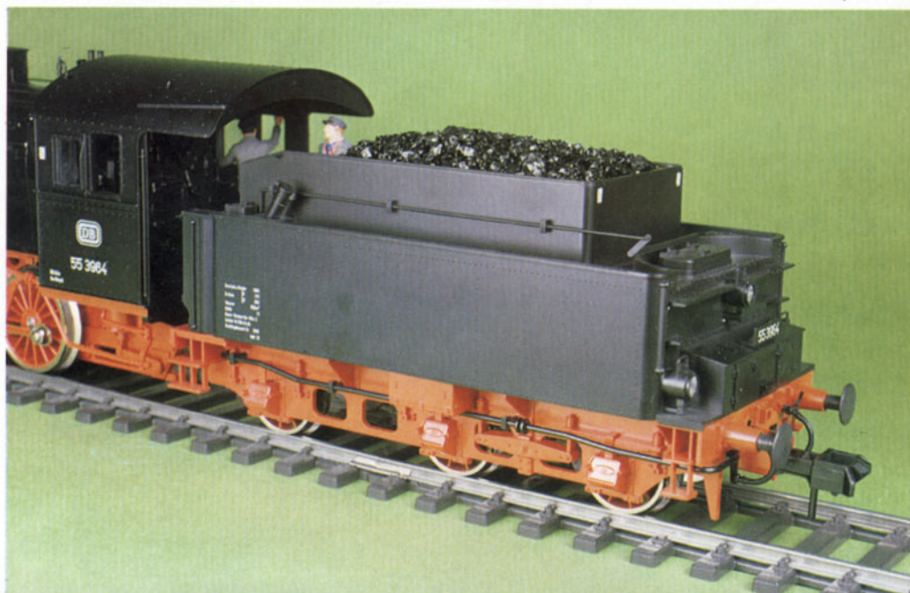
Bild 7: Im Kohlenkasten des Tenders der preußischen Bauart 3 T 16,5 befindet sich eine echte Steinkohlen-Füllung.
