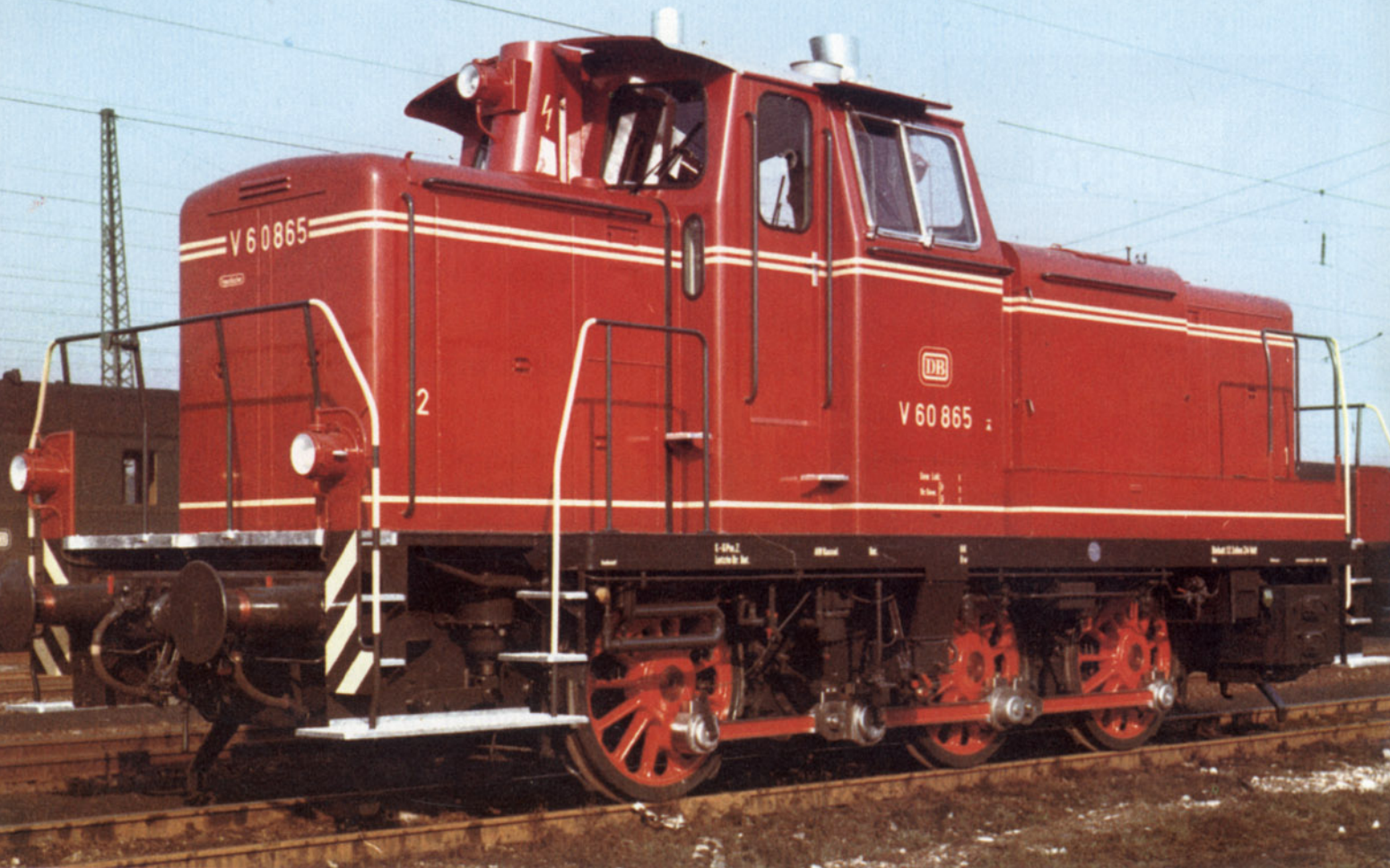
Bild 1: Bei der Abnahmefahrt der V 60 865 wurde dieses Foto aufgenommen. Die Maschine gehört zu der Serie von 50 Lokomotiven der Baureihe V 60, die Krauss-Maffel in München lieferte. Die Aufnahme dürfte um 1957 entstanden sein. Foto: Werkfoto Krauss-Maffel, Sammlung Eberl
