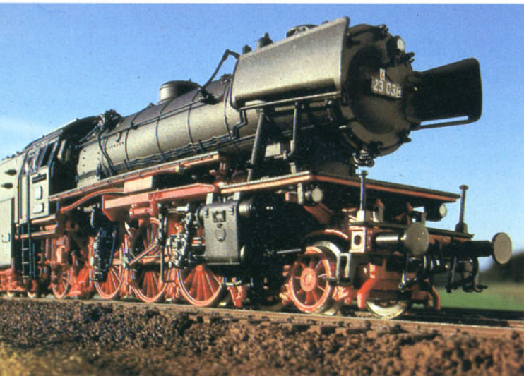
Bild 20: Sehr wichtig sieht die Roco BR 23 aus, obwohl schon im Original ein Supermodell, gewinnt die Lokomotive doch noch zusätzlich durch die Weinert Zurüstteile und die fein geätzte Metallsteuerung.
