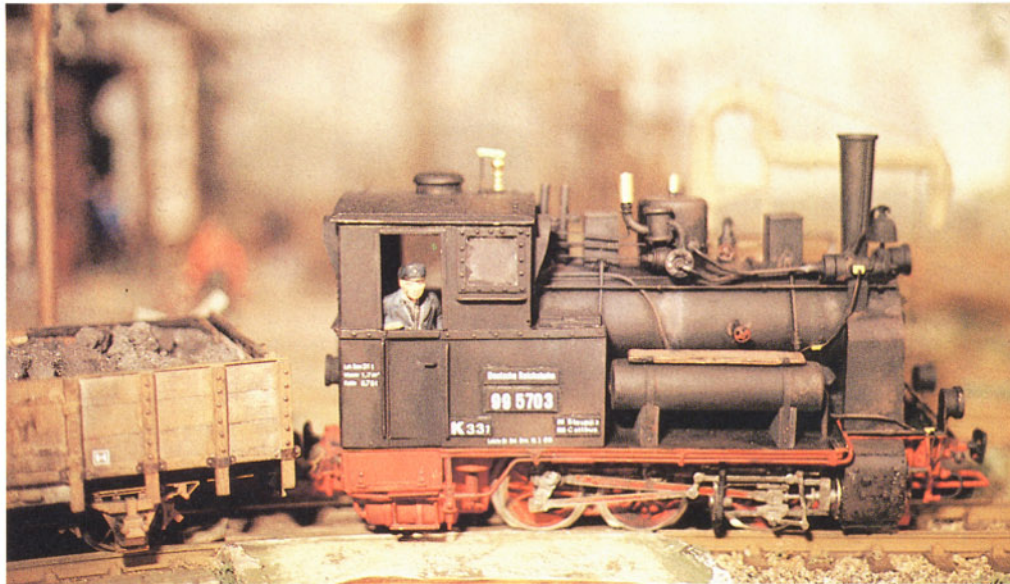
Bild 4: Die Lokomotive der ehemaligen Spreewaldbahn wurde im kompletten Eigenbau (aus Messing) auf einem LGB-Serienfahrwerk aufgebaut.
