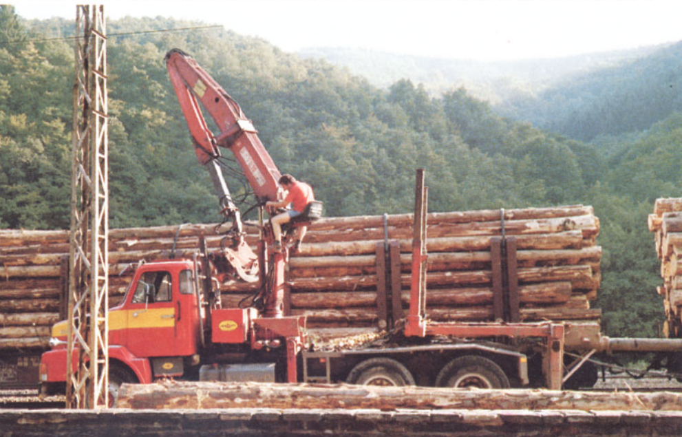
Bild 3: Der Sattelaufleger ist leer, das Zusammenlegen des Krans in die Fahrstellung hat bereits begonnen. Bei dieser Fahrzeuggattung kann der Auflieger bei Leerfahrt nicht auf die Zugmaschine verlastet werden. Die Rungen bleiben in voller Länge ausgezogen. Bei stark geneigten Frontscheiben im Sommer ein wertvolles Zubehör: die Sonnenblende.
