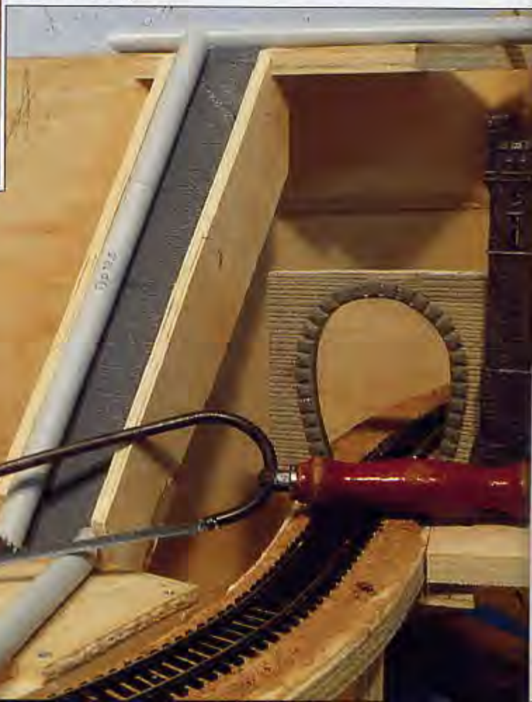
Bild 207: Das Ablängen der Elektroinstallations-Rohre erfolgt mit einer Bügelsäge.
