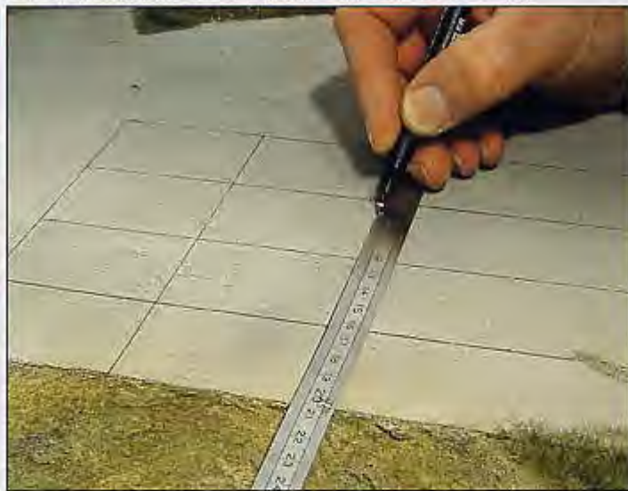
Bild 249: Das Aufzeichnen der Dehnungsfugen (Teerstreifen) auf die Betonplatte gelingt am besten mit dem schwarzen Edding.
