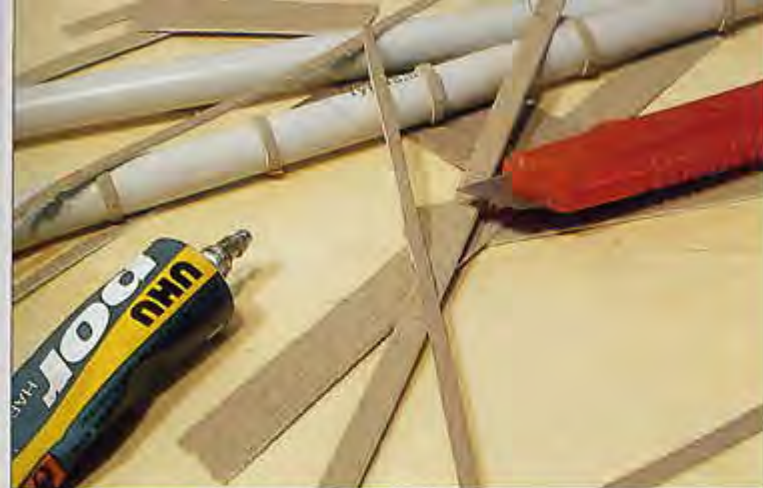
Bild 208: Mit Uhu-por werden die aus Heki-Bauplatten (Nr. 70072) gewonnenen einzelnen Streifen als Rohrverbindungen aufgeklebt.
