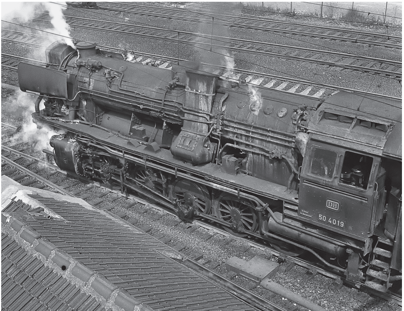
50 4019 rangiert in Mainz-Bischofsheim, 2. April 1960. Gut zu sehen: der Seitenkamin, in dessen unterem Bereich sich das Mehrfachblasrohr befindet, die sich verzweigende Speiseleitung der Dampfstrahlpumpe und der linke Hauptluftbehälter.
