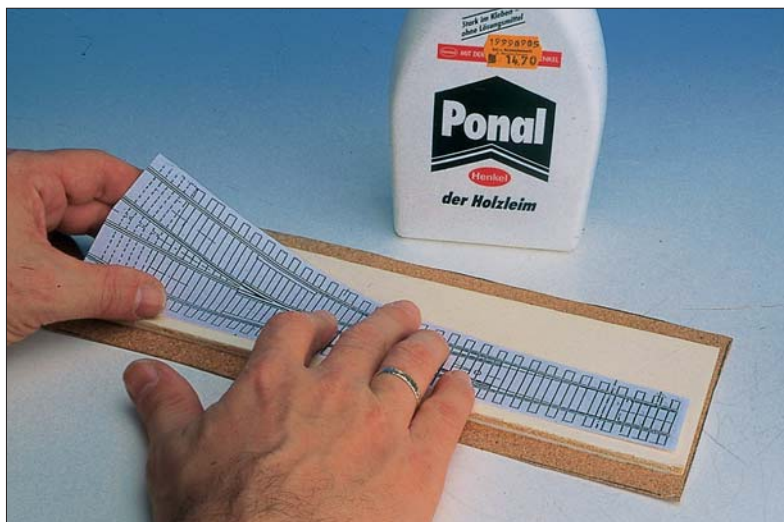
Bild 58: Obenauf klebt man die Schwellenschablone. Wenig Weißleim verhindert ein Verwerfen des Holzstreifens.
