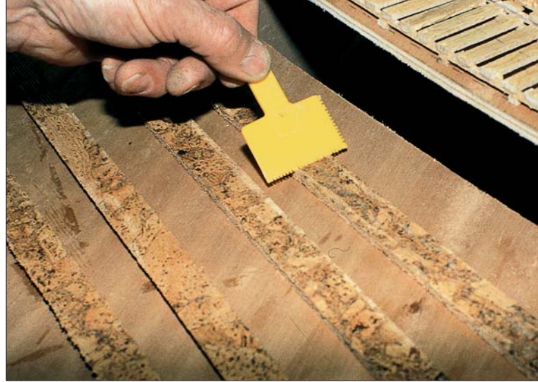
Bild 34: Korkbettung bildet den Oberbauquerschnitt.
