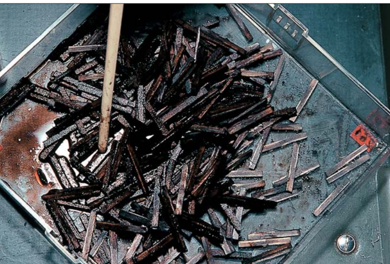
Bild 180: Die Schwellen für den Kohlebansen erhalten ein Beizebad, Farbe: Kirschbaum.
