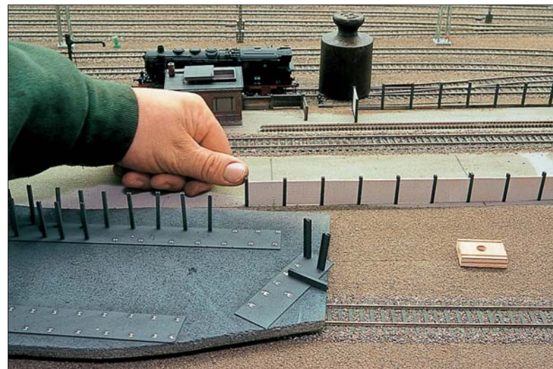
Bild 181: Die Führungen für die Altschwellen werden im genauen Abstand gesetzt.
