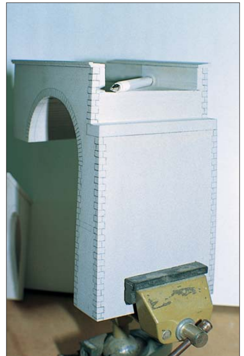
Bild 73: Die Ausmauerung der Brückenkopfenden und des Gewölbes werden vorgezeichnet. Dies geschieht einfach mit einem Bleistift.
