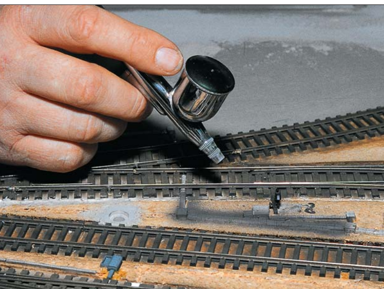
Bild 128: Mit der Spritzpistole lackiert man Schienen und Abdeckungen schnell und einheitlich.
