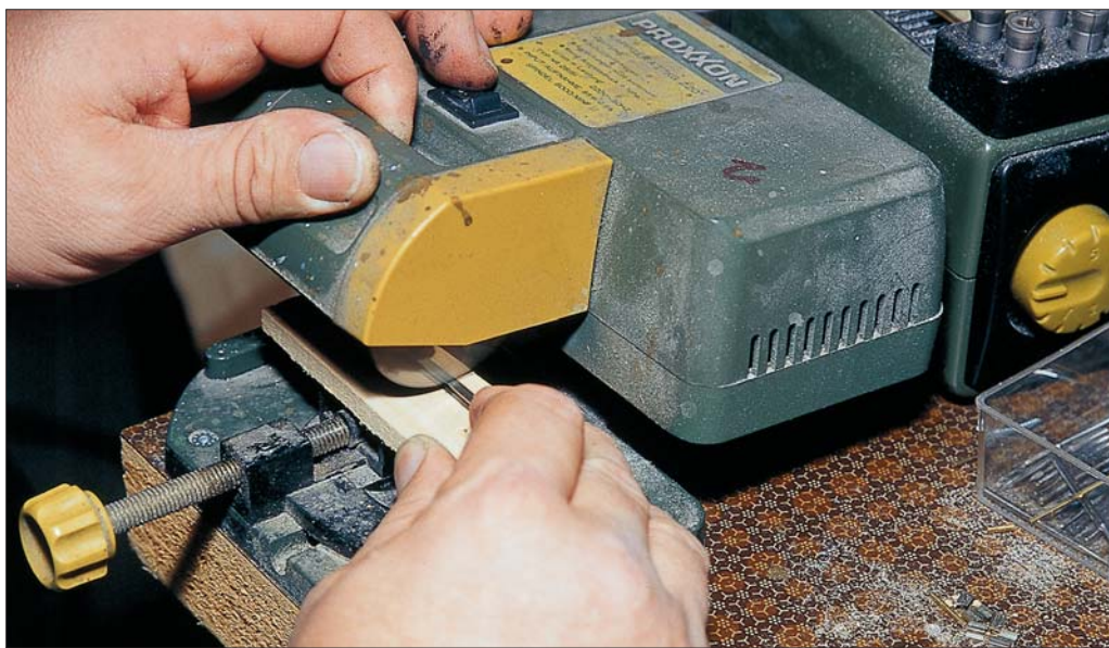
Bild 178: Entgraten mit der Schleifmaschine.
