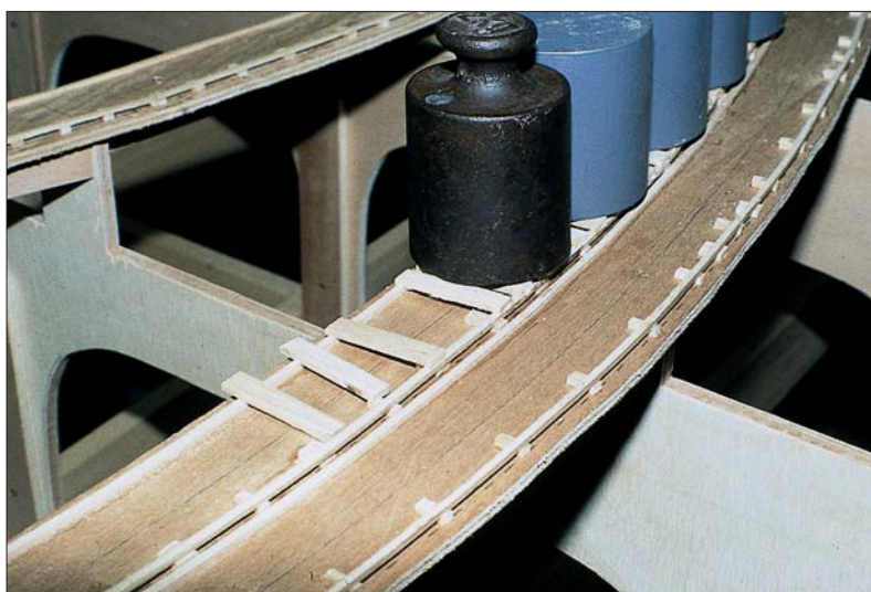
Bilder 27 bis 29: Die Trasse und Überhöhung der Kurvenbereiche werden aufgebaut. Leisten werden mit Ponal aufgeklebt und die Abbindung unterstützt.
