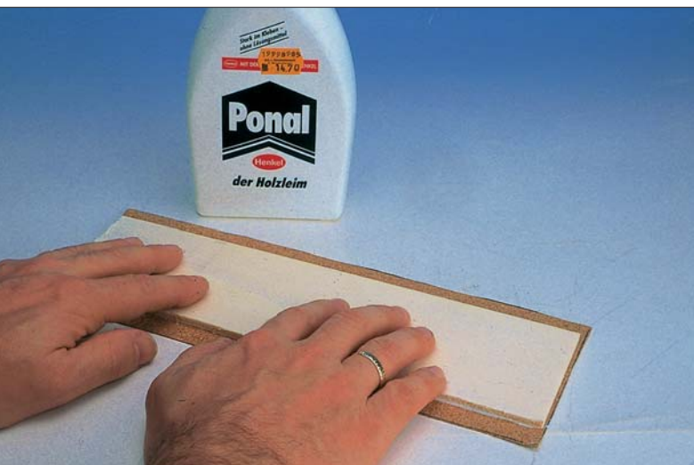
Bild 57: Das Pappelsper Holz muss wegen des Niveausgleichs zum Streckengleis mit der Korkplatte verklebt werden.
