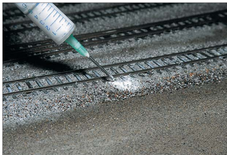
Bild 121: Ein entspanntes Weißbleimgemisch dient zur Verklebung des modellierten Schotterbettes.
