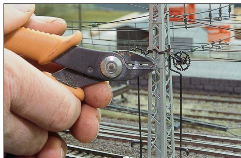
Bild 299: An der Lötstelle wird das Querseil abgekniffen.
