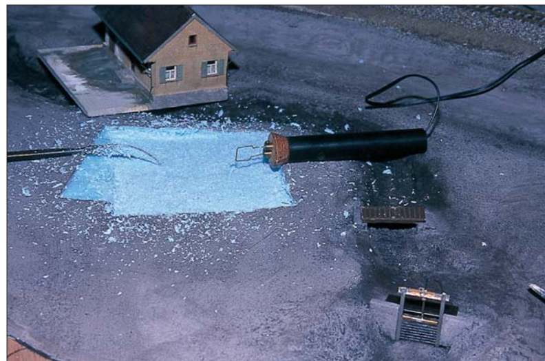
Bild 196: Feinheiten führt der Meister mit einer kleineren Variante der Heißdraht-Schneidemethode aus.
