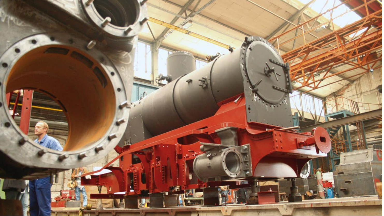
Hochzeit im Frühjahr 2009: Vereinigt harren Rahmen und Kessel in der Richthalle des Meininger Dampflokwerks auf die Komplettierung.
