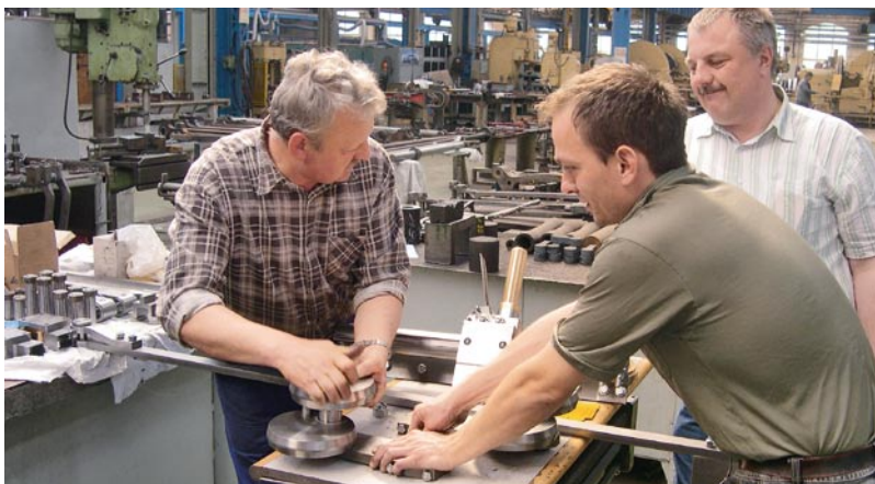
Bewegend: Für die Ingenieure um André Dörfel (rechts vorne) ist es ein Highlight des Loknachbaus, die in 3-D konstruierte und eigens gefertigte Allan-Steuerung per Hand auf der Werkbank zu bewegen.
