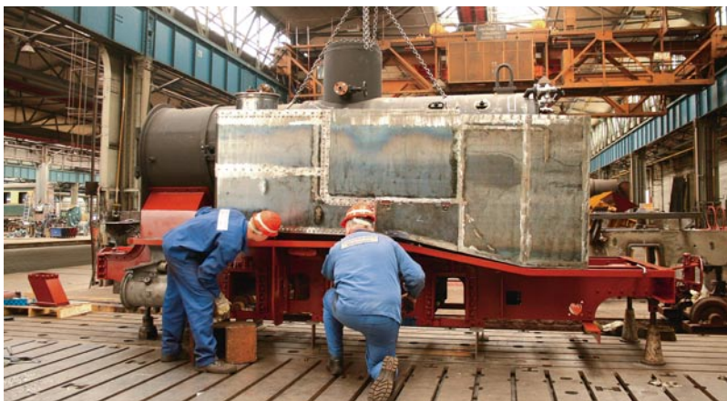
Montage des heizerseitigen Wasserkastens: Zur Darstellung der ursprünglichen Niettechnik sind die Nietköpfe einzeln aufgeschweißt.
