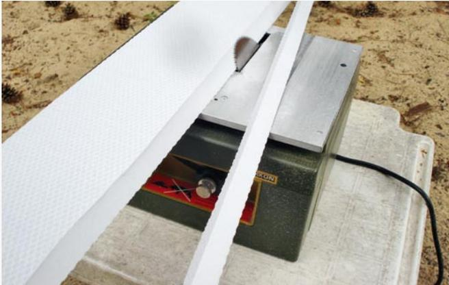
Der Zuschnitt des Bahndamms aus Styrodur erfolgt mit einer Gehrungssäge.
