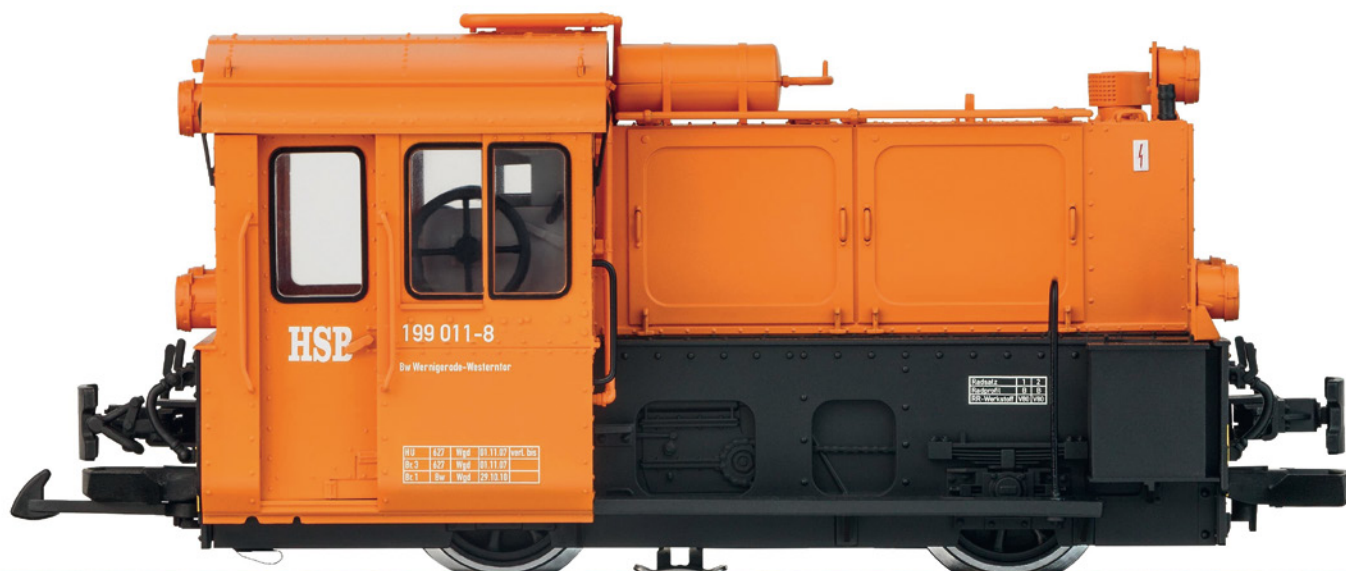
Sie wurde Anfang der 80er auf Schmalspur umgebaut und fuhr bis 2015 für DR und HSB: die KÖf II mit der Nummer 199 011.
