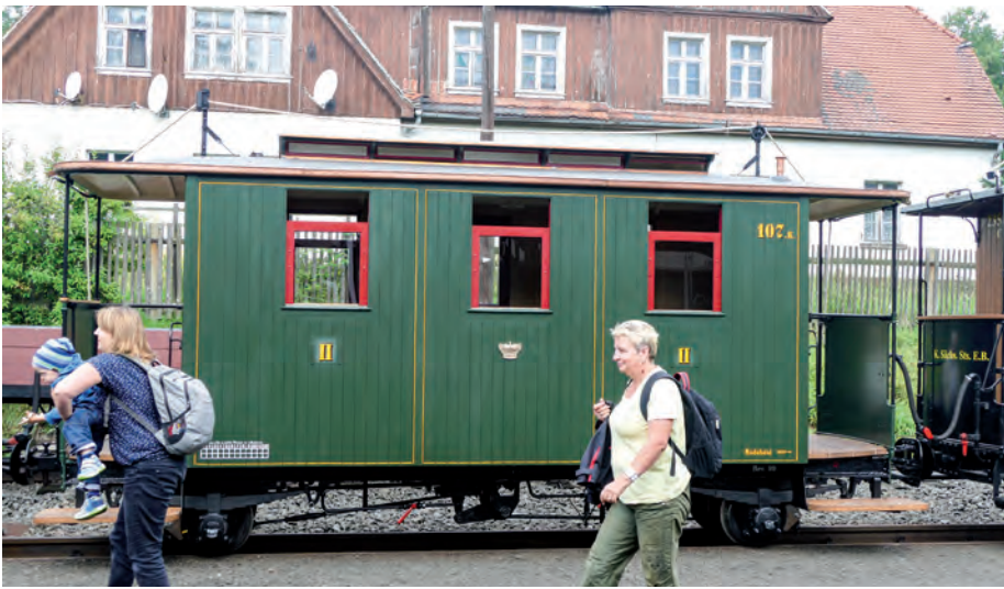
Sächsischer Personenwagen 107K von 1888: Er war der erste Sitzwagen 2. Klasse mit 750 Millimetern Spurweite. Von der Staatsbahnverwaltung 1900 auf 3. Klasse und etwa 1914 auf 4. Klasse abgestuft, endete er, fast komplett abgerissen, nahe Schönheide.
