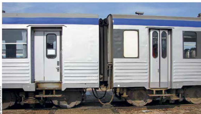
Une particularité des X 4900 modernisés: portes d'origine conservées sur les motrices et nouvelles portes sur la remorque!
