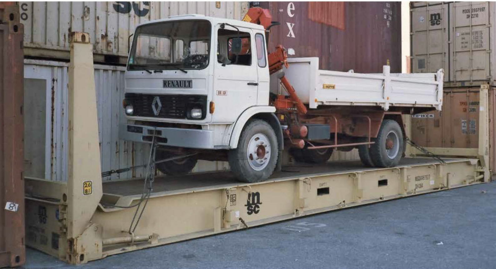
Certains types de conteneurs ISO sont étonnants. Tel, ce « flat » de MSC équipé des seuls bras en bout. Il est chargé d'un camion Renault JE13 pour l'export à Marseille-Mourepiane en 1993.
