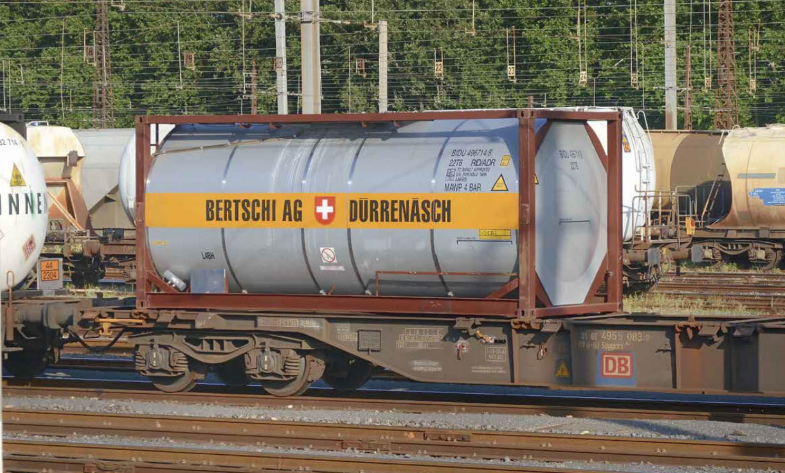
Tank du Suisse Bertschi AG. Souvent, il reste une place vide sur les longs wagons transportant des conteneurs citernes ISO en raison de la masse unitaire élevée des «tank».
