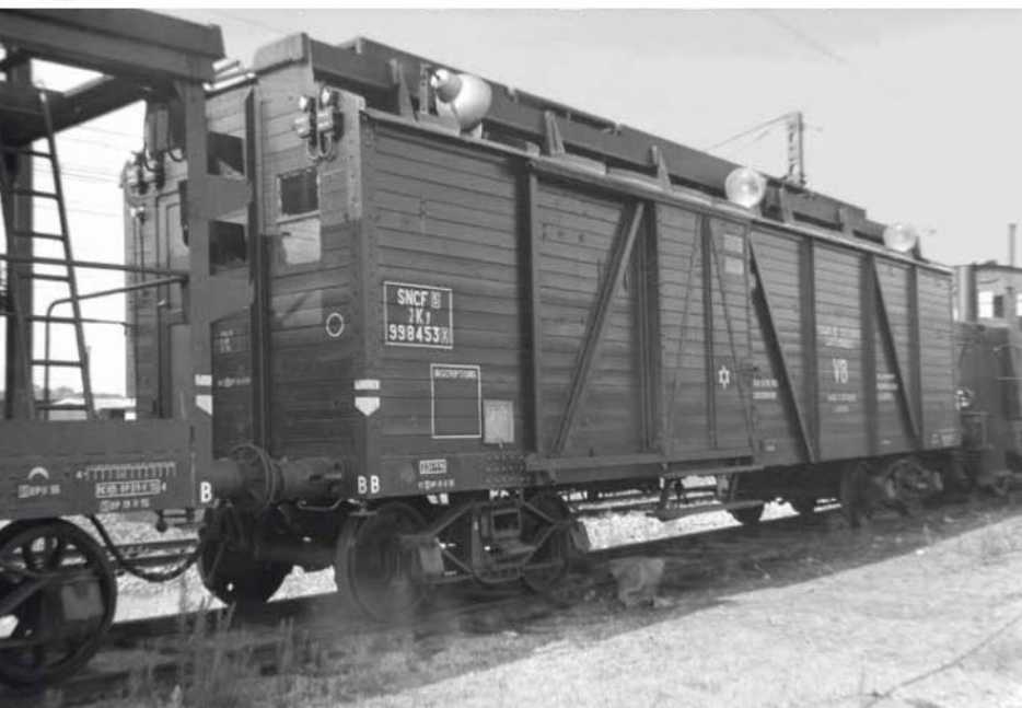
Gros plan sur le wagon couvert «outillage». Comme les autres véhicules de la rame, il possède de puissants projecteurs sur sa toiture.
