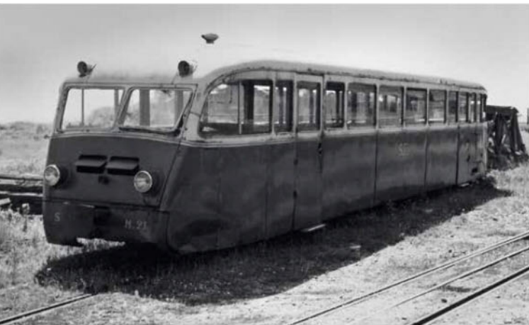
Le M21 a été construit par De Dion-Bouton en 1936 pour le Réseau Breton, exploité par les Chemins de fer Économiques, comme la Baie de Somme. Muté après-guerre sur le réseau des bains de mer, cet autorail type NR, équipé d'un moteur Willème de 180 ch, est le prototype des De Dion OC1.
