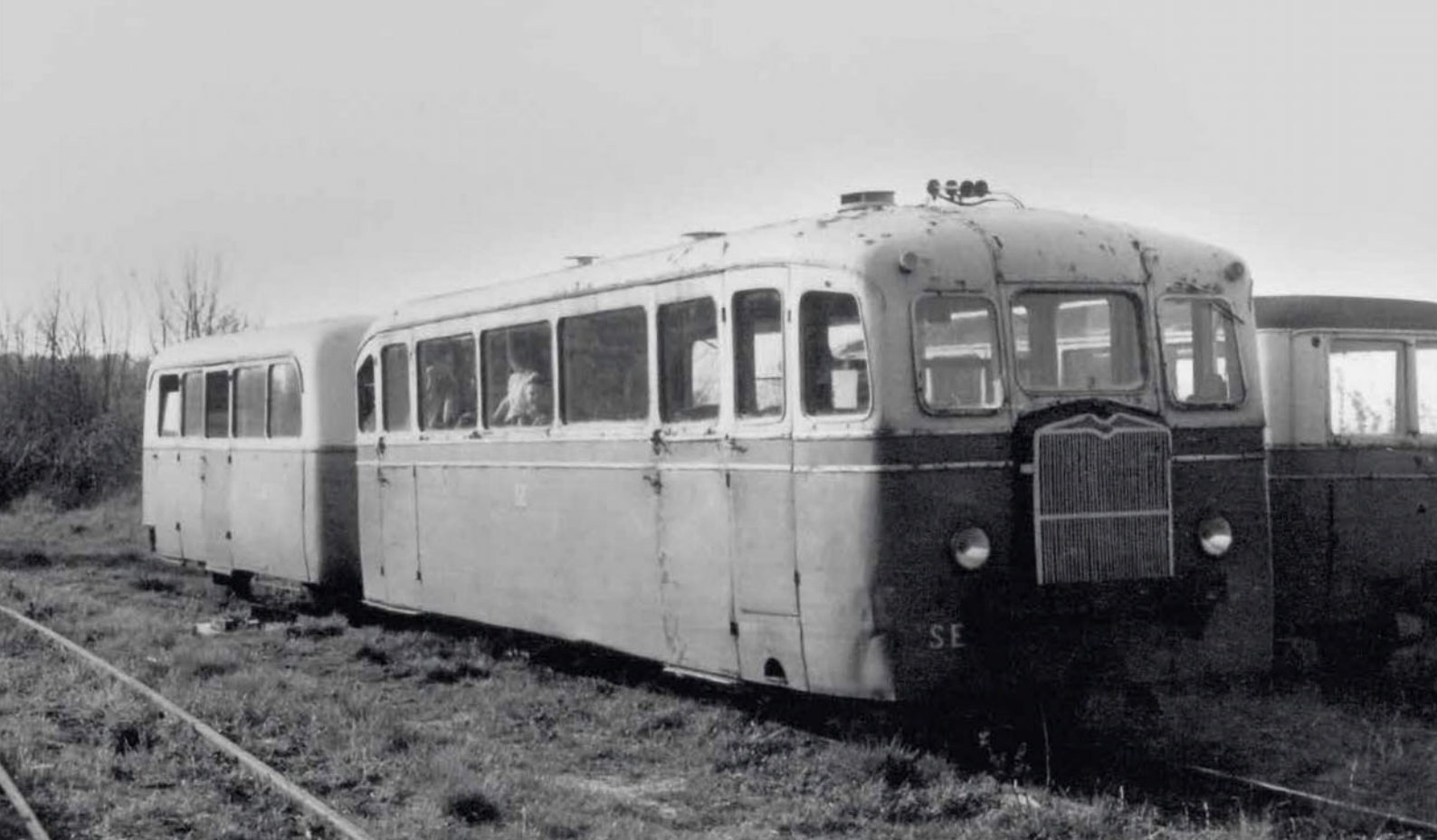
En 1939, le réseau des bains de mer reçoit deux De Dion NJ supplémentaires immatriculés M11 et M12. Ils se distinguent des dix premiers de 1937 par leurs phares disposés plus bas. Celui-ci tracte l'une des quatre remorques à deux essieux De Dion-Bouton type NO numérotées R1 à R4 attelées derrière les autorails NJ.
