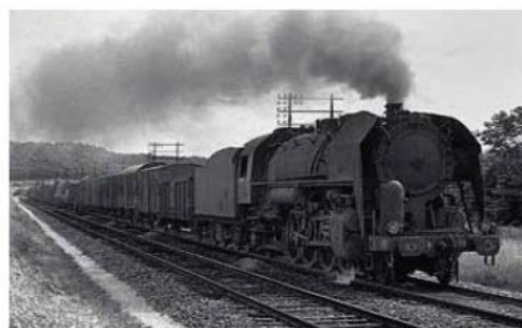
19 juin 1969: une 141 R de Nevers tracte un train du RA acheminant des wagons réfrigérants STEF au nord de la Ferté-Alais sur la voie paire. On distingue les traverses en béton monobloc sous les wagons.
