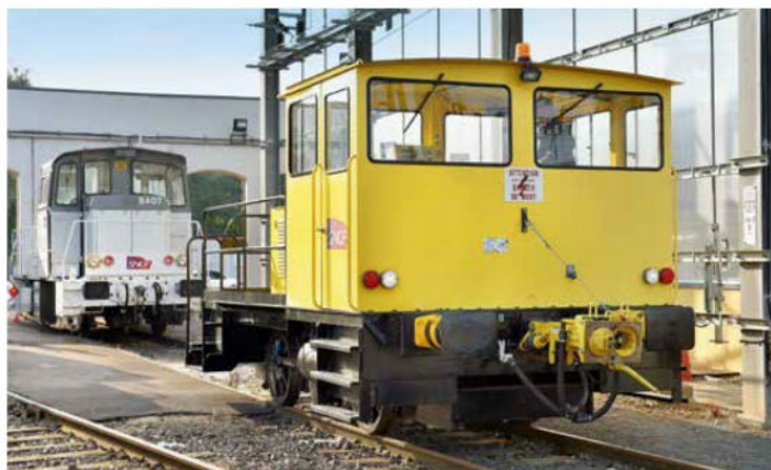
Côté cabine avec vue directe sur l'attelage ACI du Krupp.
