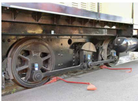
Gros plan sur l'embellage du Krupp et ses graisseurs automatiques (trois par côté).
