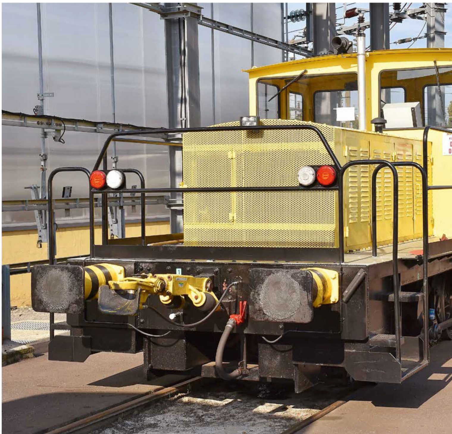
Gros plan sur le dispositif d'attelage BSI (Bergische Stahl Industrie, du nom de son fabricant) utilisé pour manœuvrer les locomotives.
