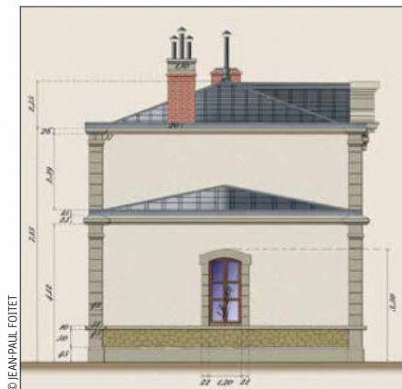
Plan en élévation de la façade côté voies. Les marquises prennent naissance au niveau des ailes en encadrant les voies.
