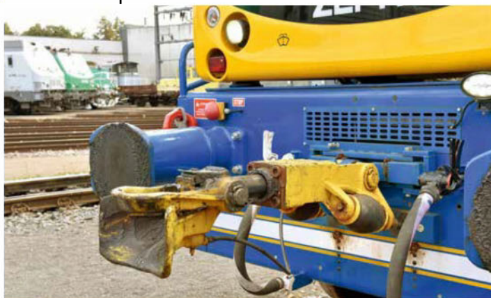
Gros plan sur le dispositif d'attelage BSI (Bergische Stahl Industrie, du nom de son fabricant) utilisé pour manœuvrer les locomotives.
