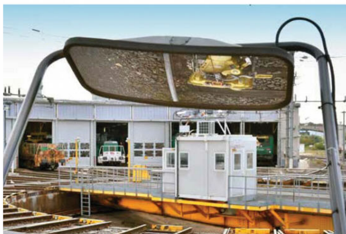
Gros plan sur le rétroviseur du Zephir permettant de visualiser l'attelage.
