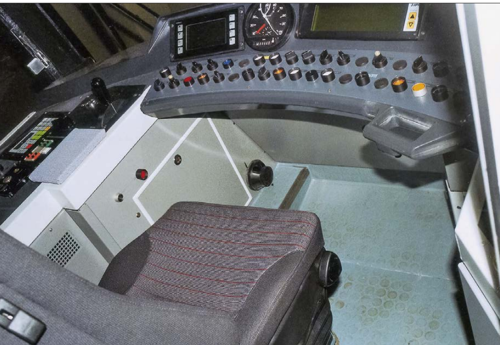
Innenansicht des Fahrerplatzes im ergonomischen Führerstand
