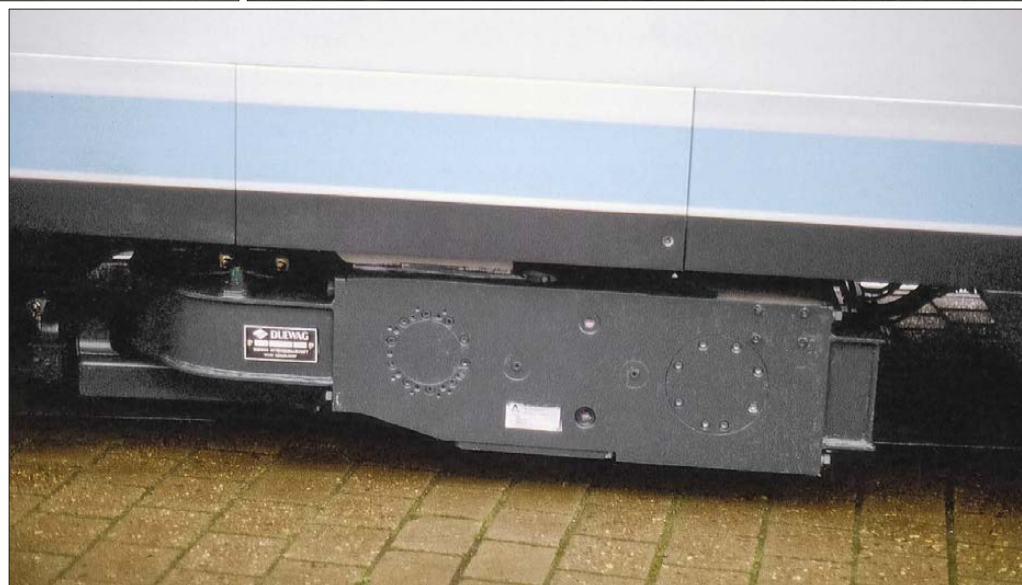
Außenansicht des eingebauten angetriebenen Fahrwerks
