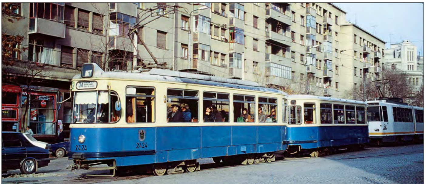
Triebwagen 2424 mit Beiwagen 3458 in Bukarest im Winter 1999 – die Drehgestelle erhielt der einst dreiachsige Wagen erst in Rumänien
