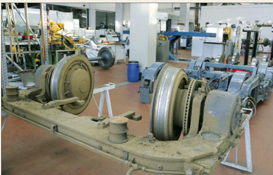
Die Wurzel des Übels: Die schadhafte Einzelrad-Einzelfahrwerke der NF6D haben dieser Wagentyp bei der BOGESTRA letztlich das Genick gebrochen. Einige Wagen haben nur 21 Einsatzjahre „geschafft“ und eine ungewisse Zukunft vor sich
