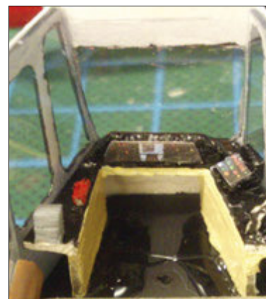
Mit einem so durchgestalteten Fahrpult kann kaum ein Industrie-Modell aufwarten. Roloff machten die Details besonders viel Spaß
