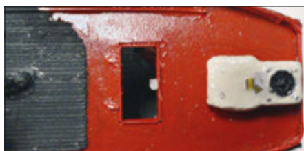
Die auf dem Dach über dem Führerstand angebrachte Klimaanlage entstand aus Balsaholz
