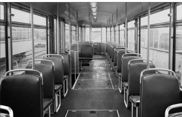
Noch einmal der Innenraum des Triebwagens. Im Gegensatz zum Beiwagen (siehe Seite 43) entfiel hier bereits der Schaffnersitz, den es im Prototypen noch gab WERKFOTO VEB WAGGONBAU GÖTHA, SAMMLUNG IVO KÖHLER
