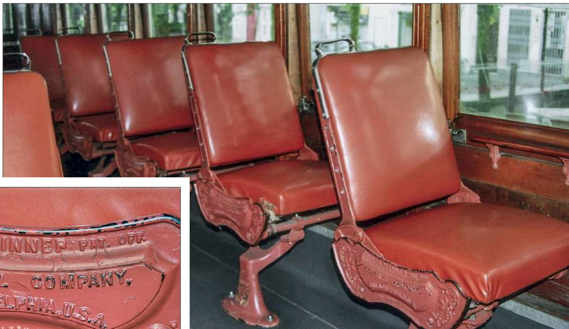
Sitze im Wagen 131 mit umklappbaren Rückenlehnen in originalen Sitzgestellen von J. G. Brill in Philadelphia, USA. Die Inschrift weist auf den Hersteller hin
