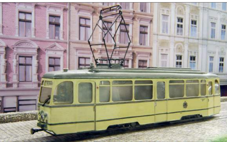
Seinen Osnabrücker Tw 55 baute Alfred Spühr schon 1956 aus Karton. Ein 1970 nachgerüsteter Faulhaber-Motor sorgt für bestes Fahrverhalten
