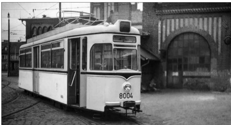
Auf dem Betriebshof Köpenick im Juni 1972. An Wagen 218 015 sind noch die später entfernten Fangkörbe (Metallgitter) unterhalb der Kupplung zu erkennen. Es scheint ein warmer Tag zu sein, wie die geöffneten Klappfenster und die vordere Tür beweisen
