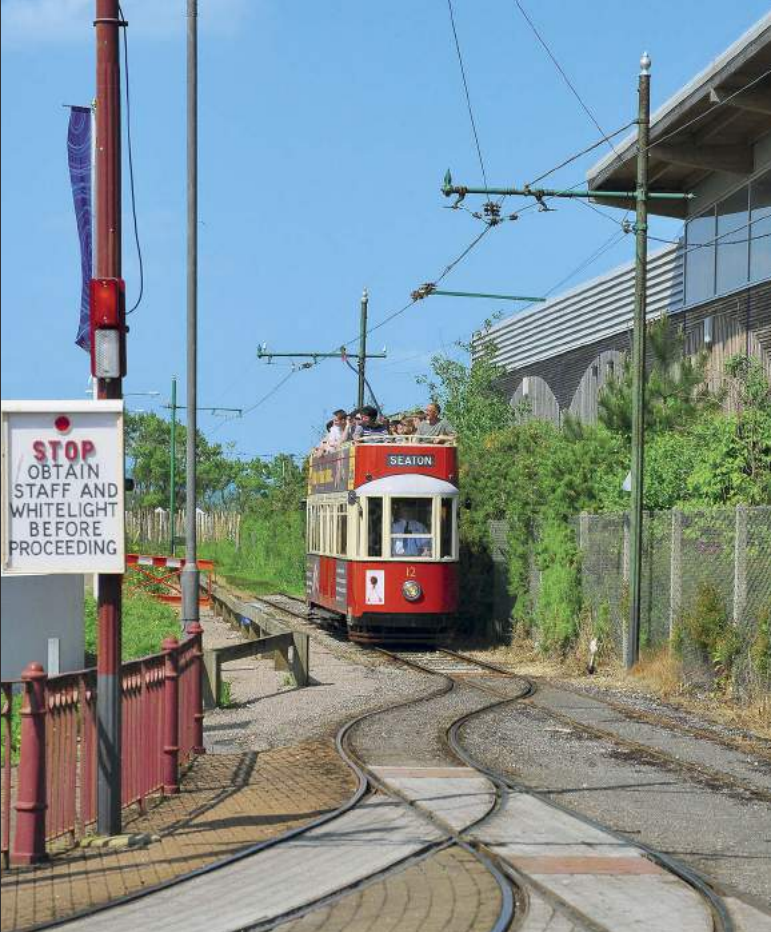
Wagen Nr. 12 aus 1966 nähert sich der Endstation Seaton. Links die optische Signalanlage, die sichert den unübersichtlichen eingleisigen Abschnitt zwischen Station und Depot
