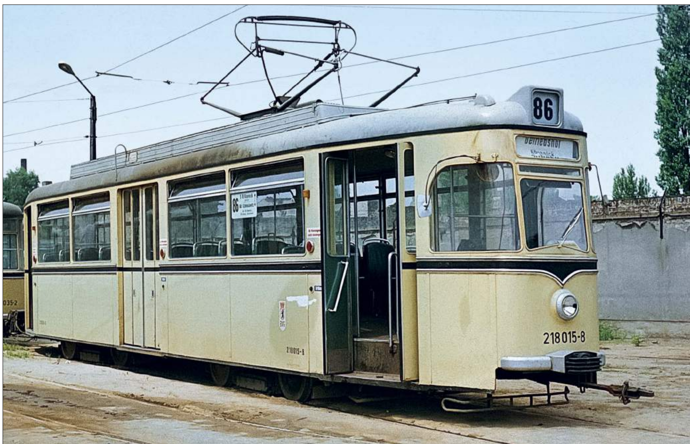
Auf dem Betriebshof Köpenick im Juni 1972. An Wagen 218 015 sind noch die später entfernten Fangkörbe (Metallgitter) unterhalb der Kupplung zu erkennen. Es scheint ein warmer Tag zu sein, wie die geöffneten Klappfenster und die vordere Tür beweisen
