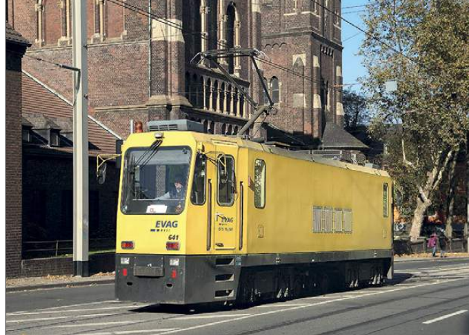
Vossloh: Der Schienenfahrzeughersteller modernisiert 2018 die beiden Schleifwagen der VIA, hier der meterspurige Tw 641 im Schleifensatz im Essener Netz
