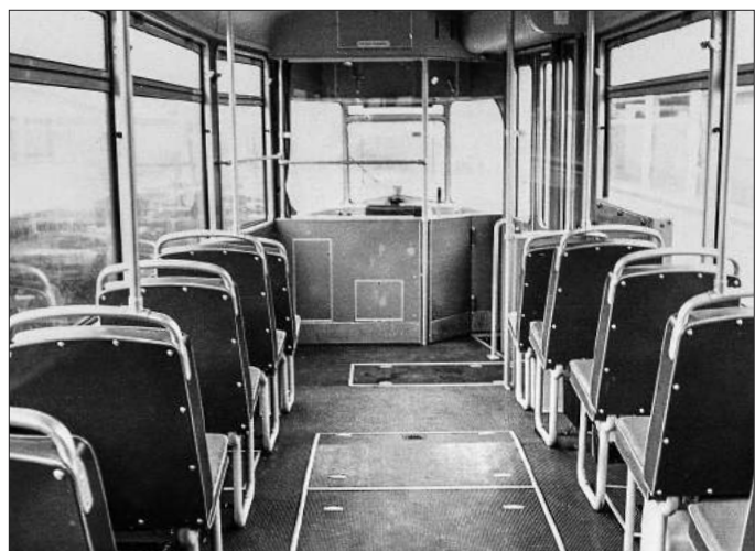
Blick in einen Triebwagen der Nullserie mit vorn angeordnetem Umformer. Erkennbar ist dies an der Bodenplatte vor der Rückwand der Fahrerkabine
