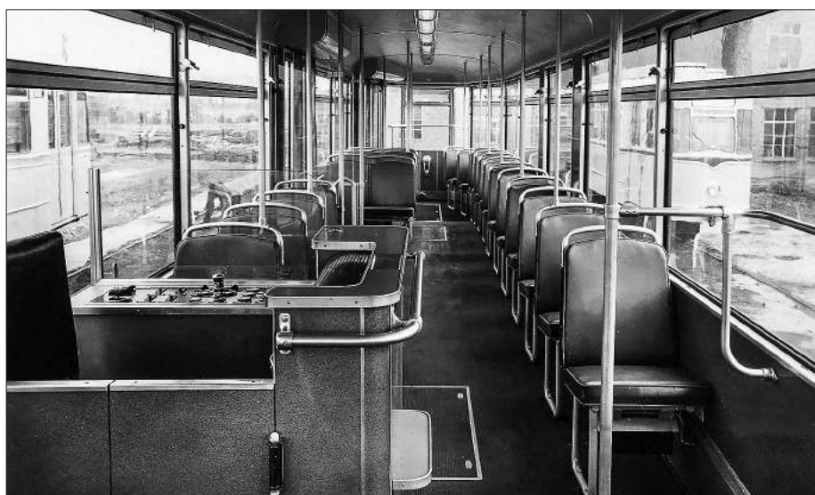
Innenraumfoto eines Beiwagens der „erweiterten Nullserie“ im Werk. Im Vordergrund ist der Schaffnerplatz erkennbar
