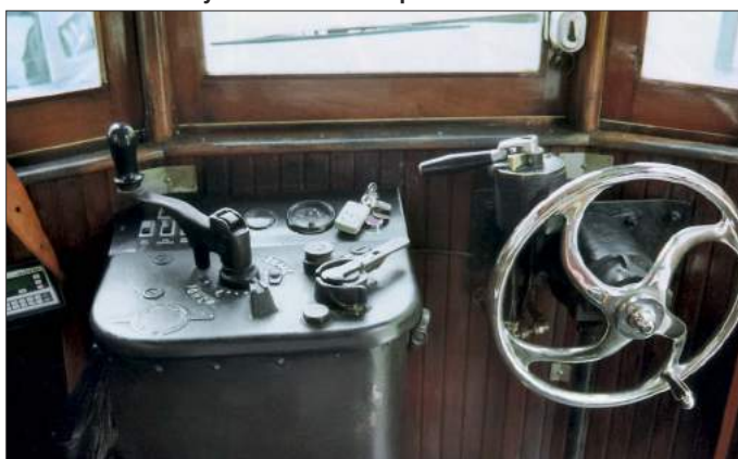
Der Fahrerstand des Triebwagens 205, ganz links das elektronische Bordinformationssystem für das Fahrpersonal
