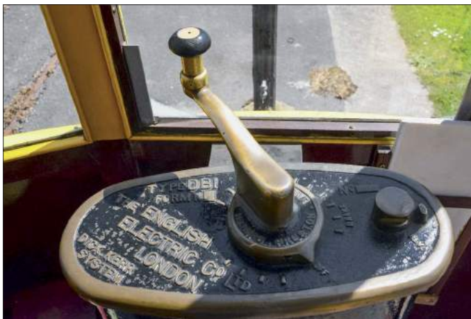
Frühe High-Tech – Fahrshalter der „English Electric Co. Ltd.“ aus London. Aufschalten erfolgt im Uhrzeigersinn
