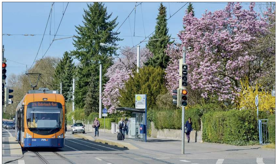
Die Strecke in der Rohrbacher Straße wurde vor wenigen Jahren komplett saniert und bekam 30-Zentimeter-Bahnsteige zum niveaugleichen Einstieg in die Bahnen
