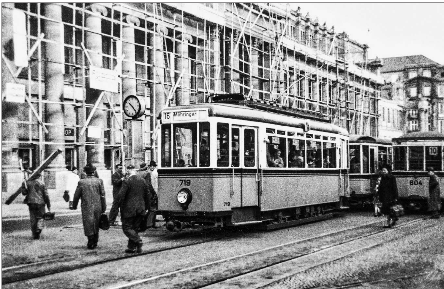
Triebwagen 719 war wegen Kriegsschäden von 1945 bis 1949 abgestellt. Bei seiner Wiederherstellung erhielt er anstelle der Liventa-Lüftungsfenster kleine Klappfenster, wie hier im Frühjahr 1950 vor dem Königsbau am Schlossplatz zu sehen ist
