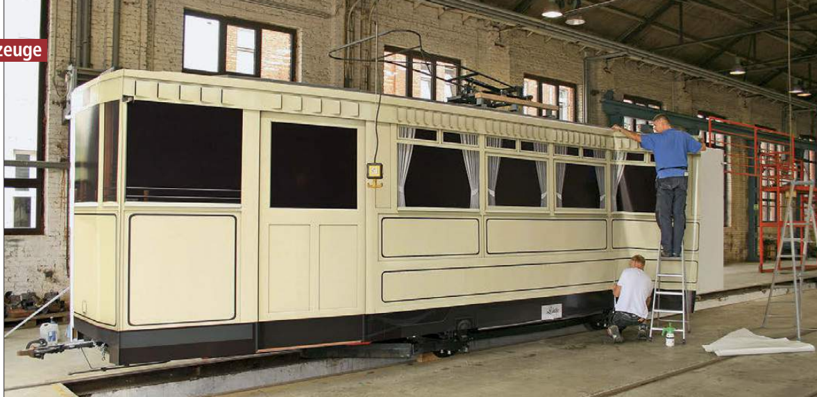
Der Arbeitswagen 557 veränderte in Magdeburg sein Aussehen – aus ihm entstand dank einem „künstlichen“ Wagenkasten ein Triebwagen der Schönebecker Vorortbahn
