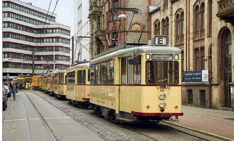
Der „Aufbautriebwagen“ Tw 239, Baujahr 1950, entstand auf Fahrgestellen kriegszerstörter Triebwagen. Die Fahrzeuge waren bis 1977 im Planeinsatz. Aufnahme während der Aufstellung vor der Parade
