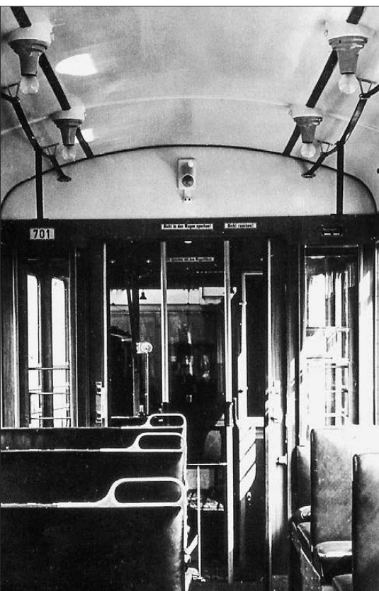
Blick in das elegante Innere: Deutlich sind auf der Plattform die zwei Stangen zu erkennen, an denen der klappbare Fahrersitz mit Haltestab anmontiert war
