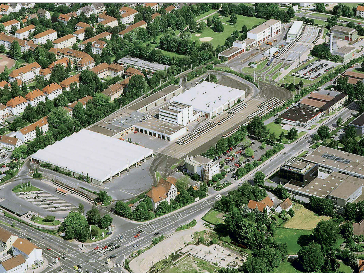
Luftaufnahme des zentralen Betriebsbahofs Sieker: Links unten liegen die Endhaltestelle Sieker sowie Park&Ride-Plätze. Die große Halle mit dem hellen Dach ist die Bus-Abstellhalle. Rechts des höheren Verwaltungsgebäudes ist die Stadtbahn-Abstellhalle zu erkennen, davor sind diverse Freigleise zu erkennen MOBIEL
