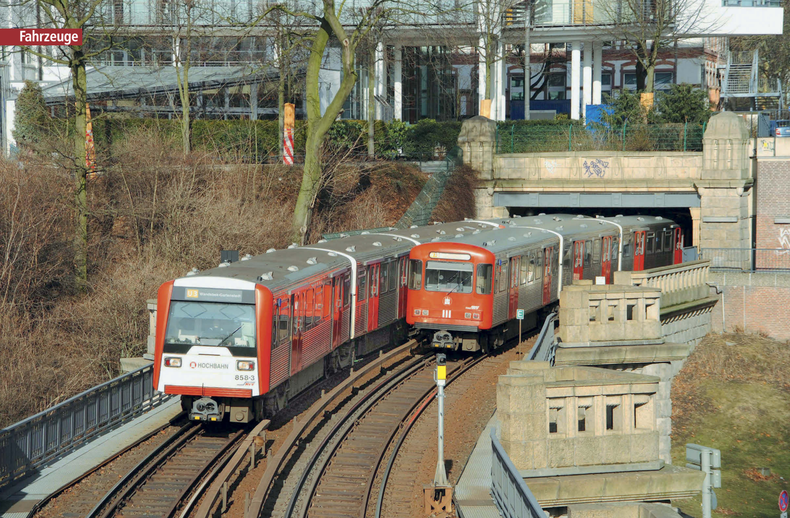
Begegnung von DT3E (links) und DT3-LZB an der Tunnelmündung Landungsbrücken im Februar 2012. Im Vergleich zur Ursprungsversion wirken die modernisierten DT3E dank ihrer „aufgemöbelten“ Frontpartie fast wie Neubaufahrzeuge, der DT3-LZB zeigt sich hingegen wenig verändert
