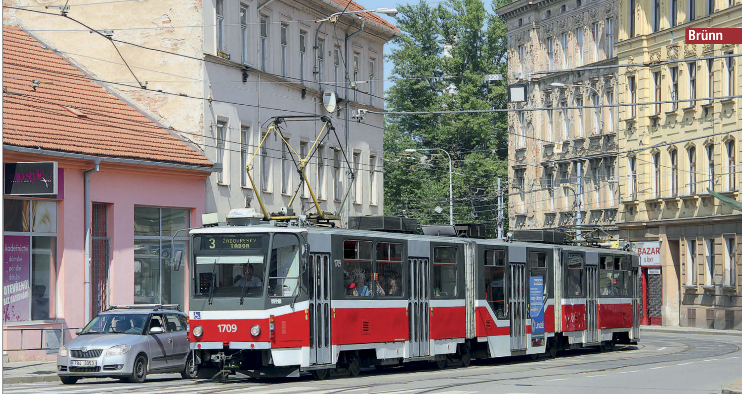
Die Zweirichtungswagen des Typs KT8 wurden zwischenzeitlich mit einem niederflurigen Mittelteil nachgerüstet, was optisch durchaus gelungen erscheint. Im Mai 2016 wartet der Triebwagen 1709 an der Ecke Vranovská und Cejl auf Weiterfahrt
