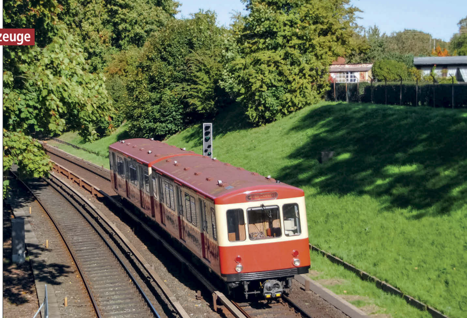
Der 1958/59 gebaute DT1 war das technische Vorbild für den DT3, doch ist der DT3 rund zehn Meter länger und trotzdem noch leichter als der DT1. Das gilt noch heute für den DT1-Partywagen in der Ursprungslackierung
