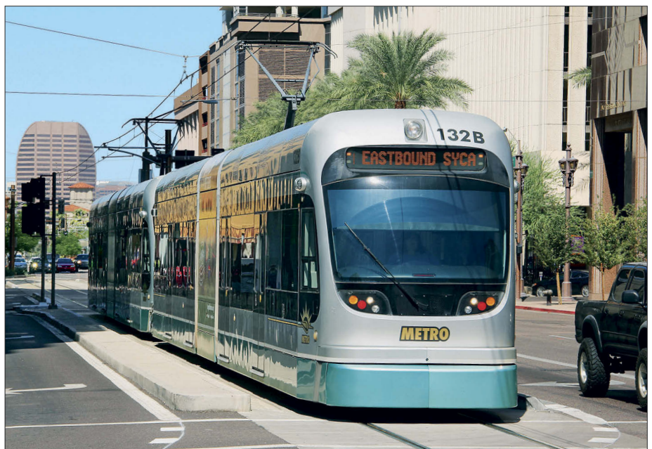
Die Wüstenstadt Phoenix hat seit 2008 eine neue Stadtbahn, Phoenix besitzt Triebwagen des japanischen Herstellers Kinki Sharyo, die auch in Doppeltraktion fahren
