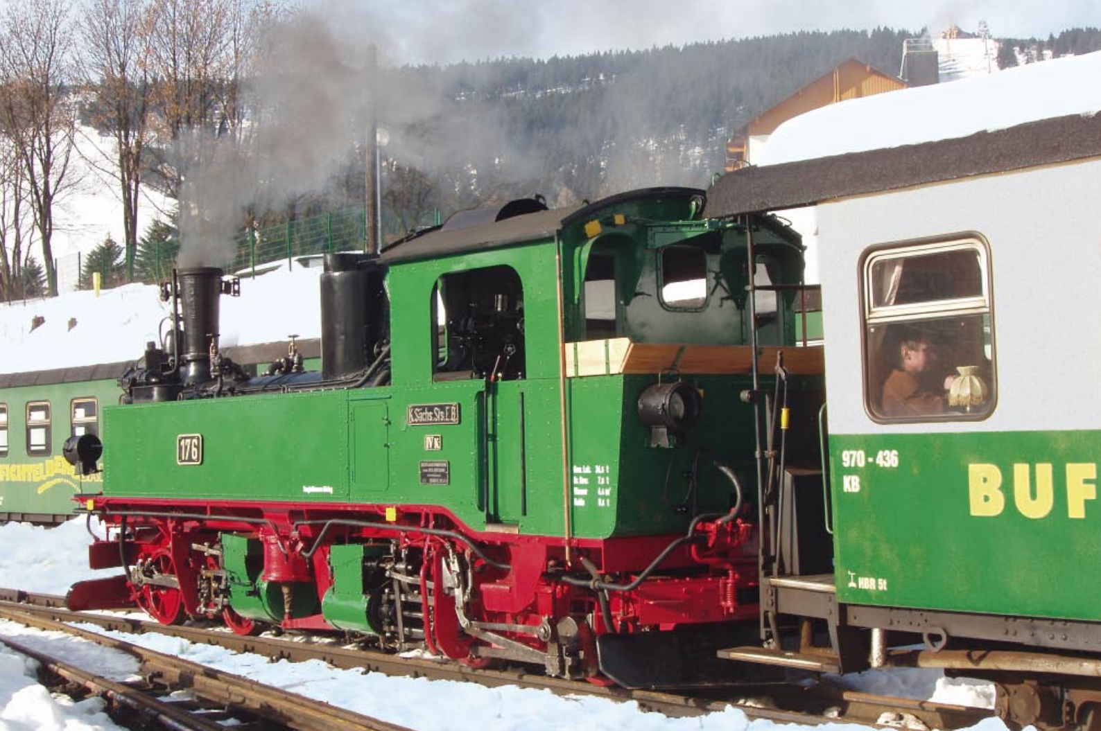
Die Werkstatt im Kurort Oberwiesenthal führte die Hauptuntersuchung an der Lokomotive 176 aus und übergab sie am 23. November 2007 dem Verein der Radebeuler Traditionsbahn.
