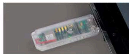
Der Koordinator in Form eines USB-Sticks stellt die Verbindung zwischen der railX-Software und den RailCommander-Modulen her.
