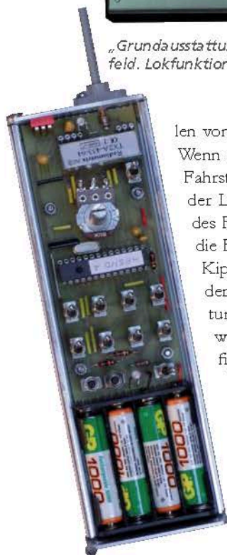
Funkhandregler mit überschaubar angeordneten Bauteilen in einem Aluminiumgehäuse
