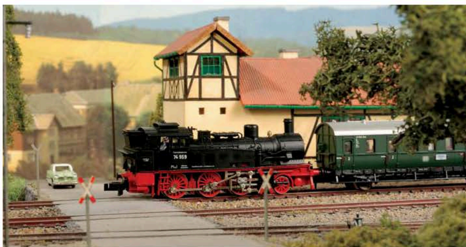
Mit dem installierten Lokdecoder N45 von Kühn lässt sich die Tenderlok der Baureihe 74 sehr feinfühlig fahren. So macht das Rangieren und gemächliche Anfahren Spaß.
