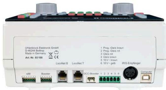
Ein Blick auf die Rückseite. Welcher Anschluss welcher Funktionalität dient, lässt sich – dank der Legende – auf Anhieb erkennen.
