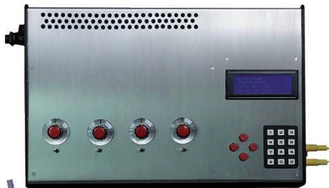
„Grundausstattung“ der MiZe 2 mit vier Reglern und Eingabefeld. Lokfunktionen werden über die Tastatur geschaltet.
