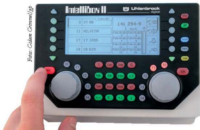
Aktiviert Funktionstasten „f0 – f4“ werden hinterleuchtet. Parallel dazu erscheint auf dem Display bei der jeweiligen Funktion ein Häkchen. Die Tasten „mode“, „menu“ und „lok“ werden ebenfalls bei Selektion beleuchtet.
