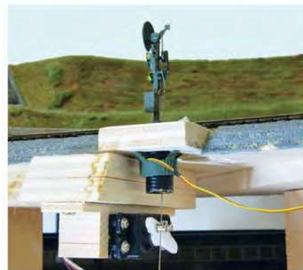
Die Standardmethode zur Servoansteuerung eines Signals. Der Stelldraht wird direkt mittels Gestängeanschluss am Servoarm fixiert.
