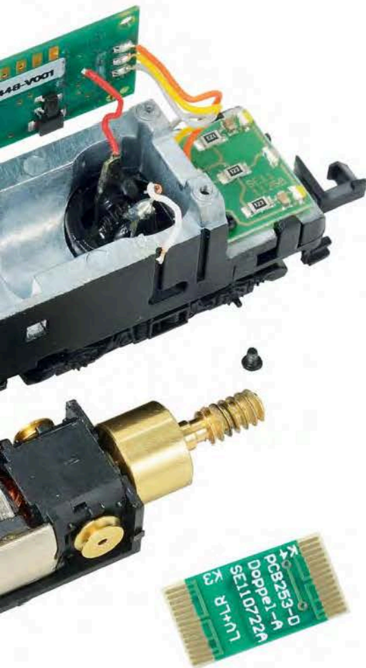
Der Analogstecker für die mTC14-Schnittstelle bietet je nach Steckrichtung unterschiedliche Lichtfunktionen.
