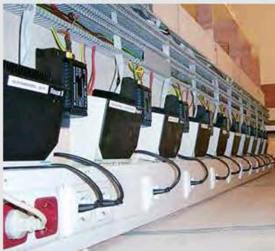
Eine lange Reihe von Boostern versorgt die Schlingensysteme der Ausstellungsanlage („Modellbahn im Museum“) mit Fahrstrom.
