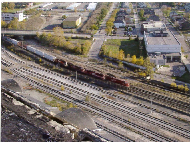
Pociąg towarowy spółki Canadian Pacific Railway mija nieczynną stację chwilę po opuszczeniu tunelu granicznego pod Detroit River. Skład prowadzi maszyna CP 8804 (GE ES44AC), za którą widzimy kolejno SOO 6061 (GM EMD SD60M), CP 9778 (GE AC4400CW) i CP 5836 (GM EMD SD40-2). Na pierwszym planie widoczny jest także fragment gzymsu koronującego budynek dworca. Poniżej pierwszej lokomotywy wprawne oko dostrzeże też pozostałości peronów adaptowane po 2000 roku do roli terminala intermodalnego.
