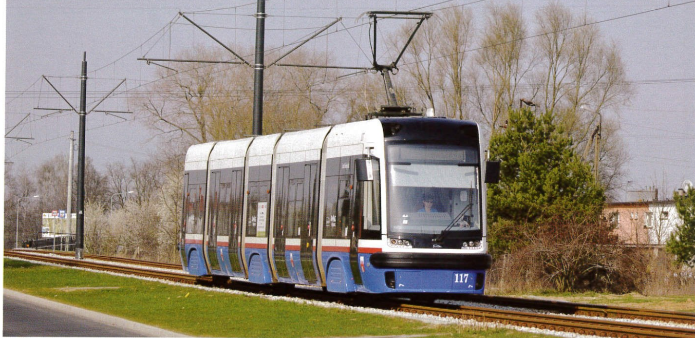
Wagon nr 117 z nietypowym dla swingów z pierwszej serii pantografem. Tego typu odbieraki zamontowane były wiosną 2016 roku na wagonach nr 114 i 117. Ul. Andersa; 05.04.2016 r.
