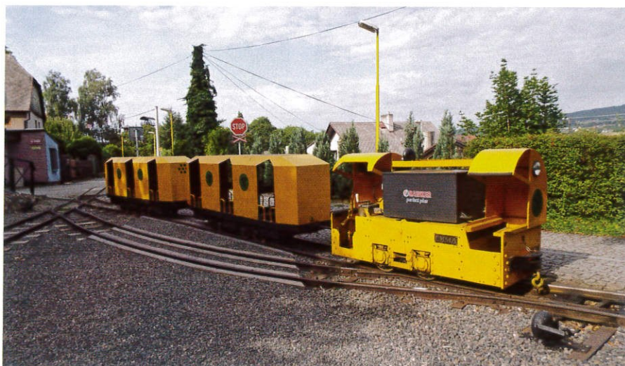
Po lewej: Górnický pociąg prowadzony lokomotywą Metallist B346 przed sztolnią Ševčinską. Po prawej: Po przejechaniu 230 metrów spod szybu Ševčinského do sztolni Ševčinskéj pociąg kończy bieg na widocznej mijance. W przyszłości pociągi będą jechały dalej sztolnią długości około 150 metrów, w której w 2017 roku rozpoczęto układanie torów.
