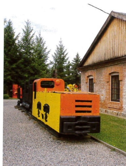
Szyb Ševčinský. Wyprodukowany w ZSRR elektrowóz drolowy typu 7KR1.
