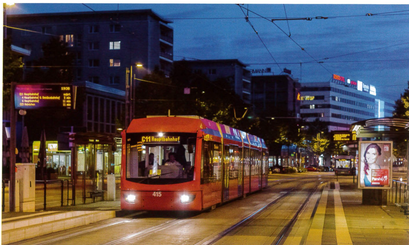
Tramwaj podmiejskiej linii C11 na przystanku Theaterplatz w centrum Chemnitz. Wagony z rodziny Variobahn zatrzymują się przy peronie o niższej wysokości. Część długości peronu (widoczną po lewej stronie) podwyższono na potrzeby pojazdów Citylink.
