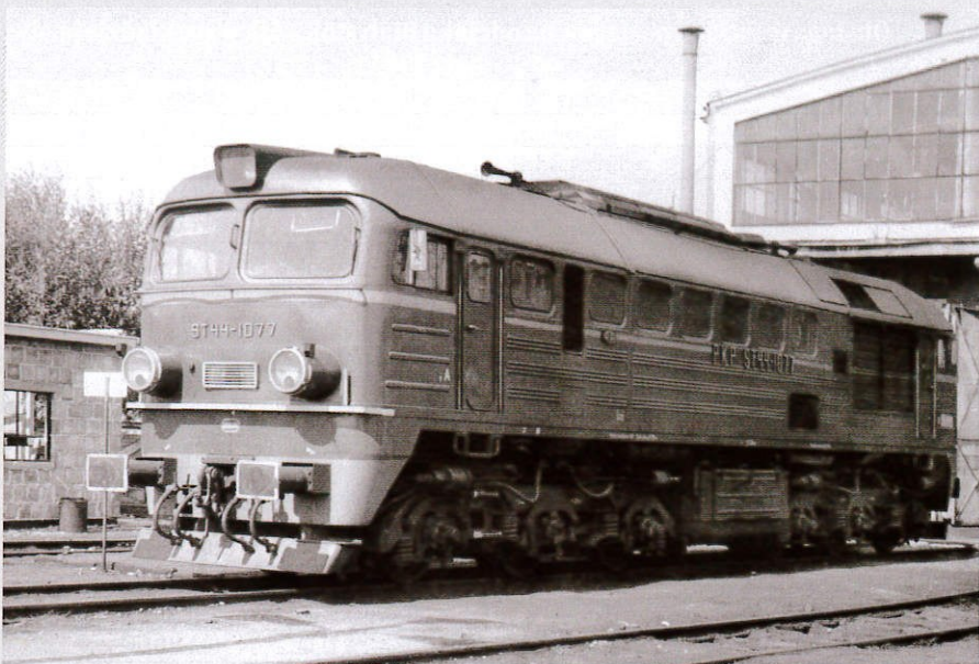
ST44-1077 była jedną z ostatnich lokomotyw tej serii przeniesionych do MD Czeremcha; na zdjęciu z 1988 roku już bez chromowanych listew na czole. Źródło: Kronika Lokomotywowni Czeremcha
