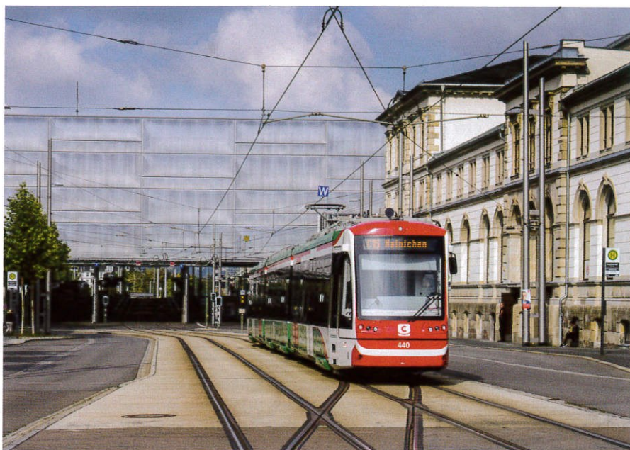
Najnowszy wagon tramwaju regionalnego za chwilę zatrzyma się na przystanku pod widoczną w tle halą peronową dworca Chemnitz Hauptbahnhof. Na pierwszym planie można zaobserwować rozjazdy wyposażone w głębokie krzyżownice.
