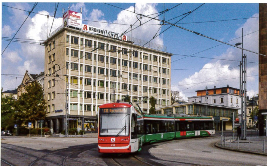
Chemnitz, Theaterplatz. Citylink na ciasnym łuku w centrum miasta. Na pierwszym członie tramwaju można dostrzec różnicę w wysokości białych drzwi zlokalizowanych w strefie podłogi na poziomie 430 mm oraz czerwonych w strefie 600 mm ponad główką szyny.
