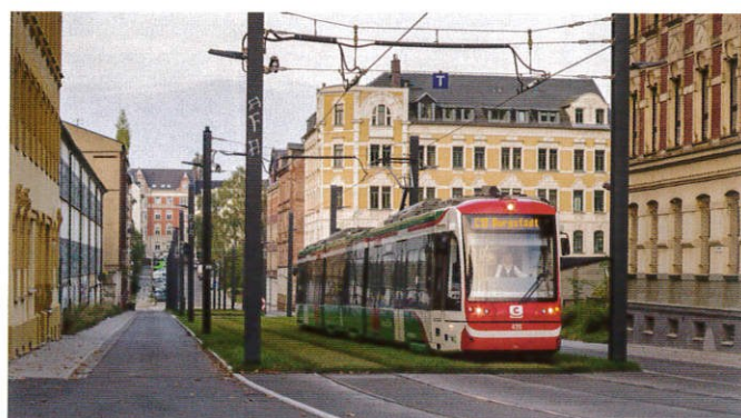
Tramwaj obsługujący linię C13 wykonuje przejazd techniczny lewym torem, aby podstawić się na początkowy przystanek Stadlerplatz. Sytuacja taka była wymuszona lokalizacją rozjazdów umożliwiających zmianę toru około 200 metrów od tymczasowego końca trasy.
