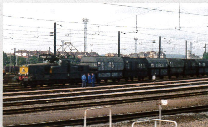
Na francuskiej stacji granicznej Thionville w pierwszym okresie eksploatacji koleje SNCF używały wyłącznie maszyn na zasilanie 25 kV/50 Hz, które wjeżdżały na tory zasilane napięciem 15 kV/16 2 /3 Hz z opuszczonym pantografem, a następnie były przestawiane za pomocą lokomotywy spalinowej. Po lewej „żelazko” BB 13017 z pociągiem nr 1349 do Metz Ville (6.11.1987 r.), po prawej BB 13000 z pociągiem towarowym do Forbach z ciekawymi, dwuosiołowymi wagonami samowyladowczymi. Thionville, 14.09.1983 r. Fot. Ph. Wormald
