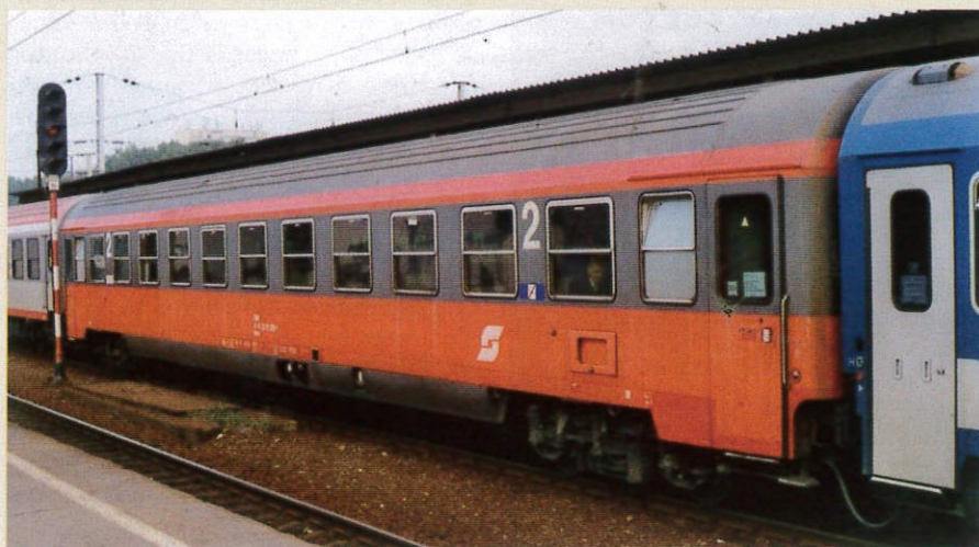
Jedna ze 105 nieklimatyzowanych, 11-przedziałowych „dwójek” standardu Z2 na wózkach typu SGP VS-RIC 75 o standardzie analogicznym do „Eurofim”, ale z otwieranymi oknami i dwukanałowym ogrzewaniem nawiewnym, na zdjęciu wykonanym na stacji Warszawa Wsch. 14.09.2008 r. w poc. 202 „Chopin” z Wien Südbhf. wagon 51 81 21-70 509-0 Brnz w czerwono-szarej kolorystyce, sfotografowany od strony przedziałów.
