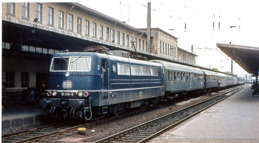
Elektrowozy dwusystemowe rozpoznawalne były po dwóch pantografach na dachu. Maszyna 181 001 z pociągiem międzynarodowym z Frankfurtu do Paryża na stacji Kaiserslautern Hbf, 8.05.1971 r. Fot. C.J. Schulze
