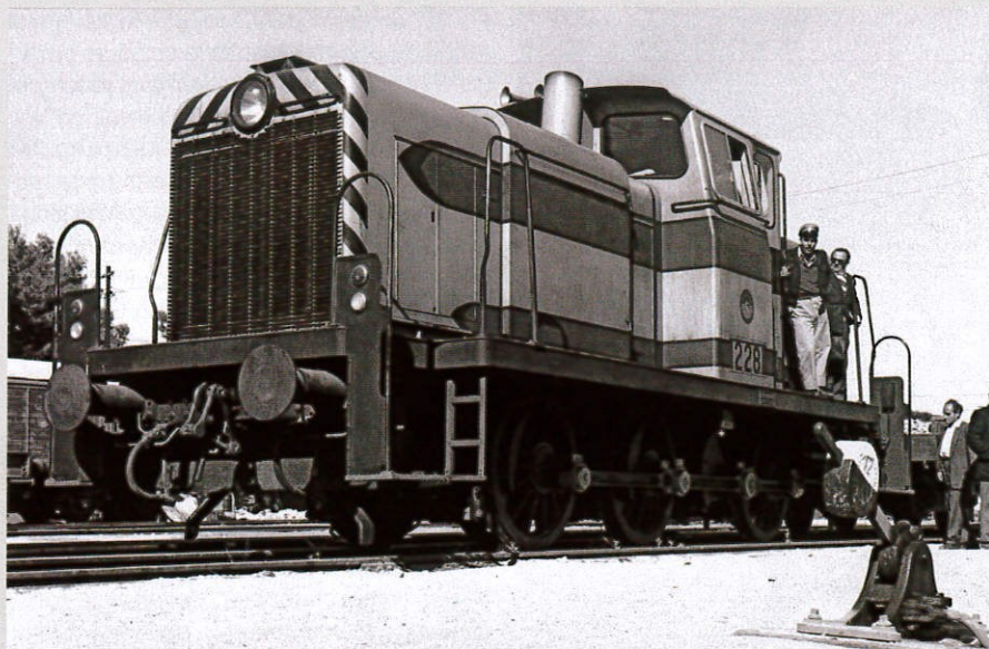
Spalinowa lokomotywa manewrowa Esslingen-Maybach nr 228 o ukt. osi 0-3-0. Dla Izraela dostarczono w latach 1955-56 dziewiętnaście takich lokomotyw, wzorowanych na serii V60 DB. Na ISR otrzymały numery z zakresu 211-229. Co ciekawe, na początku używano ich na długiej i trudnej trasie do Jerozolimy, aż do momentu pojawienia się nowych lokomotyw General Motors z Ameryki!
