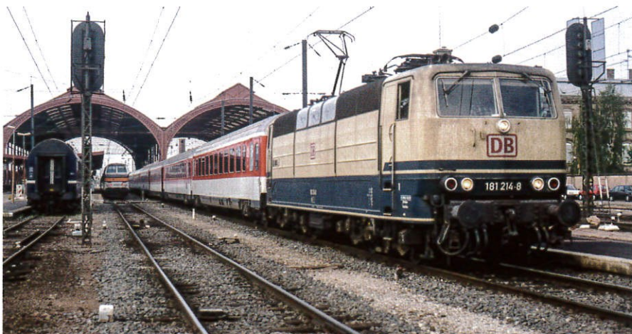
W 1974 roku kolej DB zamówiła partię 25 elektrowozów serii 181.2 będących rozwinięciem konstrukcji E 310 (181.0/181.1). Lokomotywa 181 214 w kremowo-błękitno-niebieskim malowaniu prowadzi EC67 „Maurice Ravel” relacji Paris Est (13.50) – Strasbourg – Karlsruhe – Stuttgart – München Hbf (22.11). Strassbourg to jedna z większych stacji we Francji, posiada aż pięć peronów. Po lewej widoczny skład pociągu SNCF z wagonem sterowniczym. Od 15.12.2002 r. skład wagonowy zastąpiły jednostki TGV. 23.08.1997 r. Fot. C.J. Schulze
