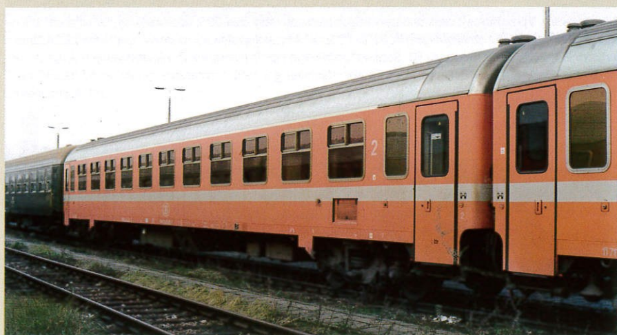
Bezprzedziałowe wagony kolei belgijskich SNCB, zarówno pierwszej, jak i drugiej klasy typu I10 w wersjach nieklimatyzowanych (część tych ostatnich wyposażona była również w klimatyzację) budowano w 1986 roku na bazie pudła 11-okienne, wymiarowo odpowiadającego wagonom standardu Z i na wózkach typu FIAT Y 0270 S t.34, z drzwiami odskokowo-przesuwными typu Faiveley z uchylnym dolnym stopniem. Na fotografiach wykonanych 13.11.1992 r. na torach postojowych warszawskiego Grochowa oba w wersji nieklimatyzowanej, u góry „jedyńka” (A 11 ) 51 88 11-70 011-2 („mały” numer 11 711), pod nią „dwójka” (B 11 ) 51 88 21-70 026-8 („mały” numer 12 726); obie w barwach pomarańczowych z szarym pasem (tzw. C1), z charakterystycznymi oknami, w górnej części dzielonymi w połowie i przesuwanymi.
