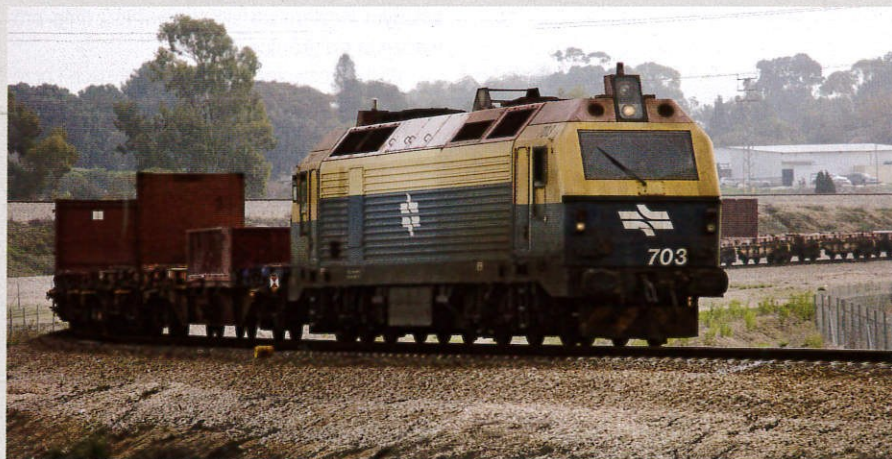
Hajfa. Lokomotywa spalinowa ISR Nr 703, jedna z ośmiu maszyn Co'Co'zamówionych w zakładach Alstom w 1996 roku z przeznaczeniem zasadniczo do ruchu towarowego.
