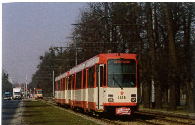
Po lewej: Gdańsk, al. Zwycięstwa. Pierwsza i jedyna niestety jazda próbna dwóch wagonów typu N8C w trakcji podwójnej, oba wagony były „pod prądem” – połączone oryginalnym sprzęgiem BSI; 25.03.2010 r. Po prawej: Kraków, pętla Borek Fałęcki. Gdański N8C 1133 na „wymianie” taborowej pomiędzy Krakowem a Gdańskiem; 31.05.2008 r.
