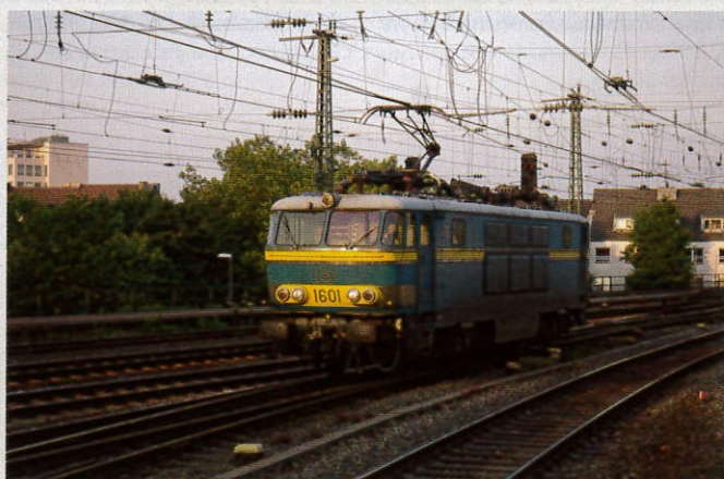
Na stacji Aachen Hbf sieć trakcyjna podzielona jest na kilka sekcji, które można zasilать odpowiednio napięciem 15 kV/16,7 Hz (DB) lub 3 kV (SNCB) w zależności od typu pojazdu. Po lewej przy jednej krawędzi peronu jednostka 206 kolei SNCB, przy drugiej krawędzi pociąg RE prowadzony maszyną DB (26.02.2005). Po prawej manewrujący belgijski elektrowóz 1601 (14.07.2005). Na sieci trakcyjnej dobrze widoczne izolatory sekcyjne. Fot. Y. Steenebruggen
