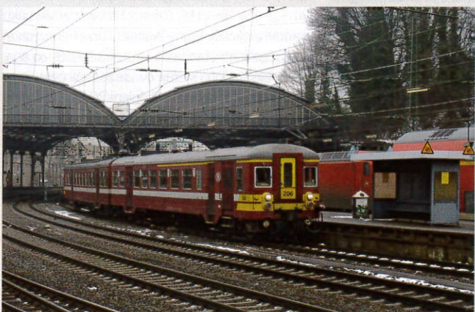
Na stacji Aachen Hbf sieć trakcyjna podzielona jest na kilka sekcji, które można zasilать odpowiednio napięciem 15 kV/16,7 Hz (DB) lub 3 kV (SNCB) w zależności od typu pojazdu. Po lewej przy jednej krawędzi peronu jednostka 206 kolei SNCB, przy drugiej krawędzi pociąg RE prowadzony maszyną DB (26.02.2005). Po prawej manewrujący belgijski elektrowóz 1601 (14.07.2005). Na sieci trakcyjnej dobrze widoczne izolatory sekcyjne. Fot. Y. Steenebruggen
