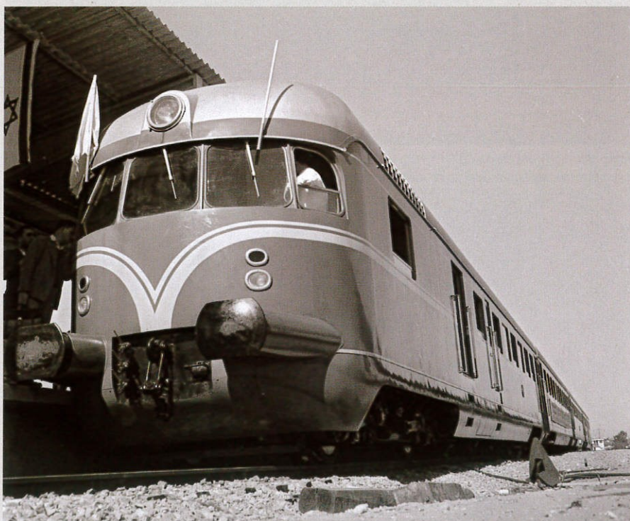
W 1956 roku Koleje Izraelskie ISR odebrały dwanaście nowych, zachodnioniemieckich spalinowych zespołów trakcyjnych, zbudowanych wspólnie przez Maschinenfabrik Esslingen, Linke-Hofmann-Busch i WMD, wzorowanych na serii VT08 kolei DB. Wyposażone w hydrauliczną przekładnię Maybacha Mekydro, pociągi te przez kilka lat utrzymywały regularną służbę w Izraelu, ale z powodu problemów z utrzymaniem i niezawodnością zostały przebudowane na wagony doczepne. Wszystkie zostały wycofane i zezłomowane, z wyjątkiem jednego wagonu sterowniczego w Tel Awiwie i jednego w Hajfie.
