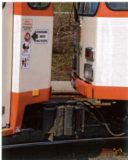
Gdańsk, pętla Chełm Witosza. Połączenie sprzęgów BSI w wozach 1138 i 1141; 25.03.2010 r.
