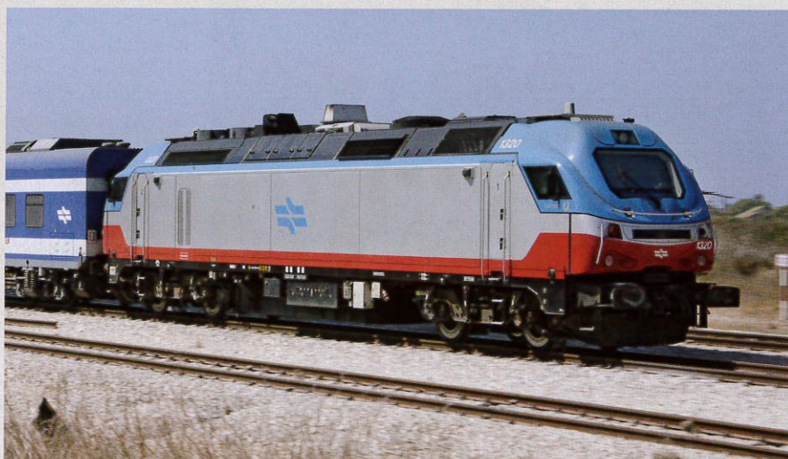
Nowy koń pociągowy ISR: 24 lokomotywy spalinowe Vossloh Euro 3200 (ISR 1301-1324), zdolne do rozwijania prędkości 160 km/h, z powodzeniem pracuje w Izraelu od 2011 roku.
