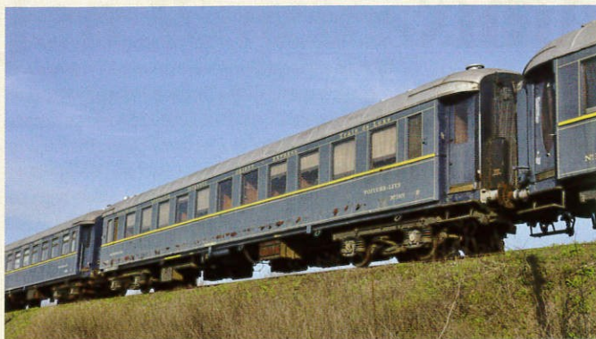
Odstawiony w Małaszewiczach wagon sypialny 51 81 06-41 006-2 WL (CIWL 3909) z widocznymi oznakami postępującej korozji, 14.04.2018 r. Fot. K Orliński
