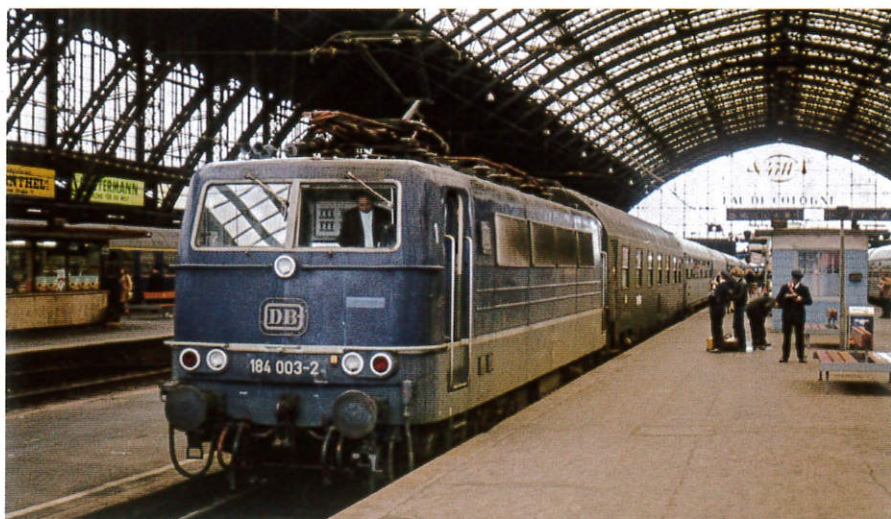
Elektrowóz 184 003 z pociągiem międzynarodowym. Jest to maszyna czterosystemowa rozpoznawalna po czterech pantografach na dachu. Köln Hbf, 18.03.1974 r. Fot. C.-J. Schulze
