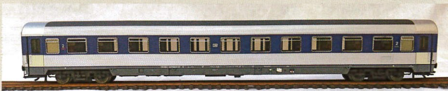
Drugi z modeli prototypów DB z ryflowanymi pasami podokiennymi – wagon 2 klasy 51 80 21-70 001-9 Bwüzm 237 (LS Models nr kat. 46 011 w zestawie dwuwagonowym z „jedyńko-dwójką” 51 80 30-70 001-8 ABwüzm 227 ) w pierwotnym malowaniu „pop” z niebieskimi: pasem okiennym i górną częścią drzwi odskokowo-przesuwnych, na zdjęciu od strony przedziałów.
