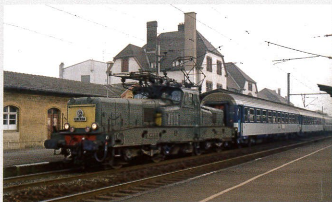
Na francuskiej stacji granicznej Thionville w pierwszym okresie eksploatacji koleje SNCF używały wyłącznie maszyn na zasilanie 25 kV/50 Hz, które wjeżdżały na tory zasilane napięciem 15 kV/16 2 /3 Hz z opuszczonym pantografem, a następnie były przestawiane za pomocą lokomotywy spalinowej. Po lewej „żelazko” BB 13017 z pociągiem nr 1349 do Metz Ville (6.11.1987 r.), po prawej BB 13000 z pociągiem towarowym do Forbach z ciekawymi, dwuosiołowymi wagonami samowyladowczymi. Thionville, 14.09.1983 r. Fot. Ph. Wormald
