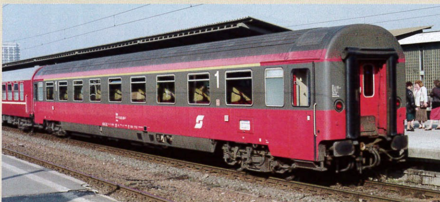
Klimatyzowany, 9-przedziałowy, czerwono-szary wagon pierwszej klasy kolei ÖBB, wzorowany na „Eurofimach”, ale na wózkach SGP VS-RIC 75 z oznakowaniem 61 81 19-70 100-0 Amz, sfotografowany od strony przedziałów 21.04.1996 r. na stacji Warszawa Wsch. w pociągu EC „Sobieski” do Wiednia Płd. To pierwsza z 15 klimatyzowanych „jedynek”, wyprodukowanych w zakładach Simmering Graz Pauker w Simmering w 1982 r. (oznaczone zostały jako 61 81 19-70 100 ÷ 19-70 114 Amz).
