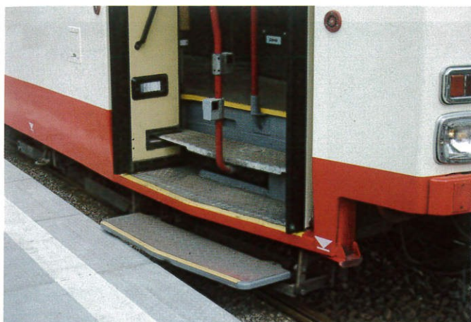
Gdańsk, pętla Zaspa, przystanek ówczesnych linii 12 i 4. Stopnie wagonu 1140 wysuwane dla ułatwienia wsiadania; 3.04.2007 r.
