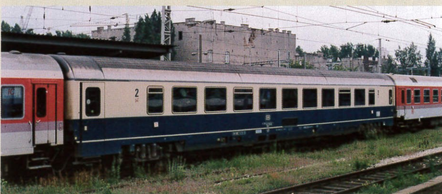
Koleje DB po otrzymaniu 100 przedziałowych „Eurofim” 1 klasy zakupiły w latach 80. ub. wieku partię 540 bezprzedziałowych wagonów 2 klasy serii Bpmz 291+293 , wymiarowo odpowiadających standardowi Z – miały one dziewięć okien szerokości 1400 mm oraz dwa szerokości 900 mm, 80 miejsc siedzących oraz wyposażone były w wózki typu Minden Deutz MD-52. Na zdjęciu jeden z nich, oznaczony jako 61 80 20-90 012-1 Bpmz 291,3 (290) w niebiesko-kremowej kolorystyce, sfotografowany 13.06.1994 r. na stacji Warszawa Wsch. w poc. EC 41/71002 „Varsovia” z Berlina Hbf. Fot. A. Etnanowicz
