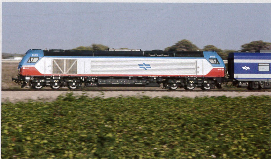
Nowa lokomotywa spalinowa Vossloh Euro 4000 z pociągiem pasażerskim na głównej linii do Hajfy. Czternaście tych potężnych lokomotyw Co'Co' (ISR 1401–1414) zostało zakupionych w 2011 roku do przewozów towarowych i pasażerskich.
