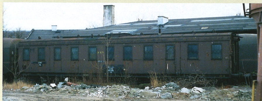
Czteroosiowy „bocznik” typu Cz 36 000 „Centoporte” FS, już po przebudowie na PKP na techniczno-gospodarczy, na zdjęciu wykonanym 20.12.1993 r. na stacji Warszawa Główna jako 421 997 XHa, poprz. 801 018 XXo, poprz. 870 224 XXo (nr FS nieznan), również z zachowanymi przejściami w ścianach czołowych. Fot. A. Etmanowicz
