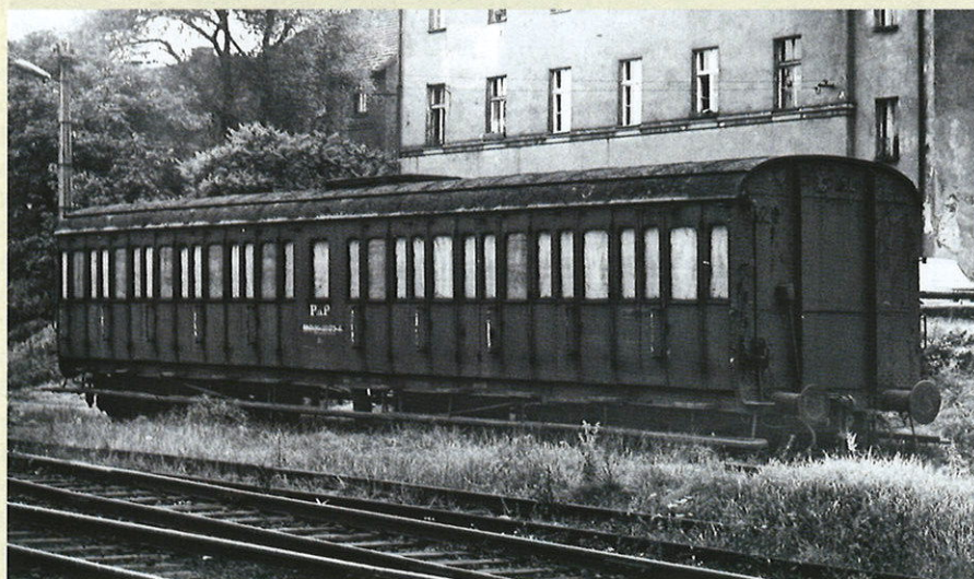
Czteroosiowy „bocznik” 50 51 20-20 173-4 Bx, już skreślony z inwentarza, z przekreślonym numerem (ostatnia napr. rew. 20.01.1970), sfotografowany na stacji Oświęcim 15.07.1976 r. To włoski Cz 36 000 „Centoporte” (pierwotny numer FS 36 414), na PKP po 1945 roku po likwidacji przejść w ścianach czołowych i harmonii otrzymał oznakowanie 020 290 Cx.
