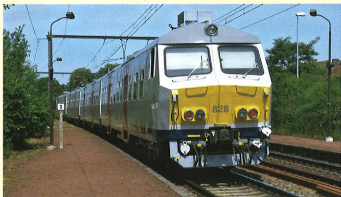
Jednostka AM75 828 po modernizacji otrzymała nowe, jasnoszare barwy z żółtym czołem; wyposażona w dodatkowy górny reflektor po uzyskaniu ponownej homologacji będącej obsługiwania pociągów w relacji Antwerpia – Roosendaal (NS). Wijgmaal, 28.05.2018 r. Fot. Y. Reynaert
