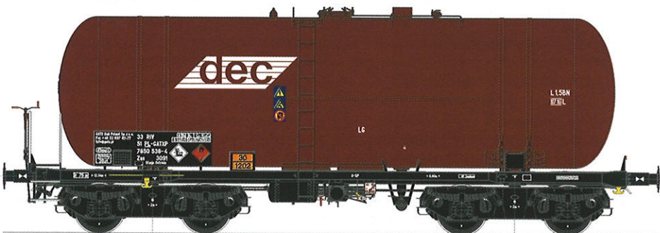
Rysunek wagonu typu 406Rb, serii Zas, nr 33 51 7850 538-4, należącego do GATX Rail Poland Sp. z o.o., w oznaczeniach PL-GATXP z epoki VI (nr kat. 58361C). Stacja mac. Ostróda; 6 REV 1008 (GATX Ostróda) 25.07.12. Oprócz wspomnianego już braku oznaczeń na dennicach zbiornika i czółownicach wagonu, ciekawostką są w tym przypadku znaki ostrzegawcze na zbiorniku, wykonane już zgodnie z przepisami niemieckimi, a także nalepka z kodem kreskowym umieszczona na tablicy z numerem wagonu.
