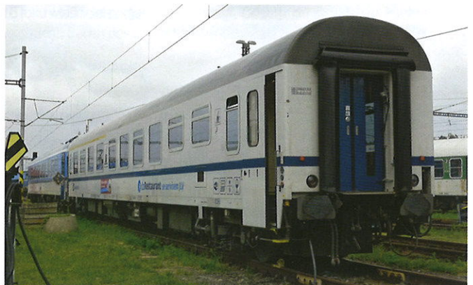
Zmodernizowany wagon osobowy klasy 1 z przedziałem bufetowym o nr. 61 54 85-71 001-1 serii ARmpee.832 odstawiony na terenie wagonowni Bohumin, 28.04.2015 r.
