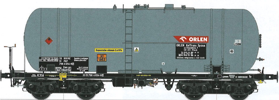
Rysunek wagonu typu 406Ra, serii Zaes, nr 33 51 798 4 654-8, należącego do Orlen Koltrans Sp. z o.o., włączanego do taboru PKP, w oznaczeniach z epoki Vc (nr kat. 58451). Stacja mac. Płock Trzepowo, CZ Łódź; 4 REV 1036 (ZUT Wągrowiec) 88.10.31. Typowy przykład oznakowania w wykonaniu ZUT Wągrowiec, bez napisów „Ostrożnie przetaczać” na dennicach zbiornika.
