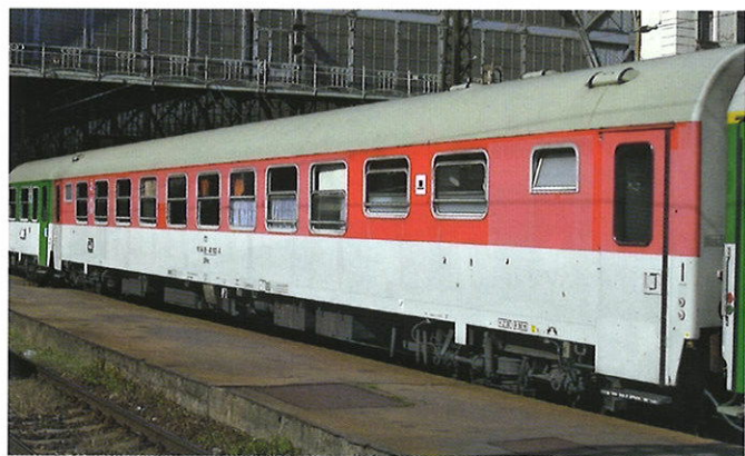
Wagon 51 54 85 40-002-9 BRm.830 w składzie pociągu IC 140 „Detvan” relacji Praha hl.n. – Zvolen. Wagon ten był jednym z sześciu przebudowanych w 1994 roku z likwidacją rozkładanych leżanek i zastąpieniem ich standardowymi fotelami. Praha, 29.06.2005 r. Fot. P. Fiala
