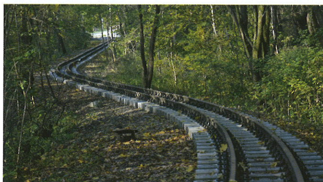
Widok na tor od strony pętli Zwierzyniec – na tym odcinku wykorzystano szyny starożytnie S42 – choć zamontowane w 2001 roku, były wyprodukowane w 1985 roku; 5.11.2017 r.
