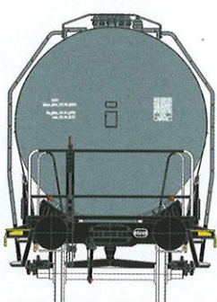
Rysunek wagonu typu 406Ra, serii Zaes, nr 33 51 798 4 654-8, należącego do Orlen Koltrans Sp. z o.o., włączanego do taboru PKP, w oznaczeniach z epoki Vc (nr kat. 58451). Stacja mac. Płock Trzepowo, CZ Łódź; 4 REV 1036 (ZUT Wągrowiec) 88.10.31. Typowy przykład oznakowania w wykonaniu ZUT Wągrowiec, bez napisów „Ostrożnie przetaczać” na dennicach zbiornika.
