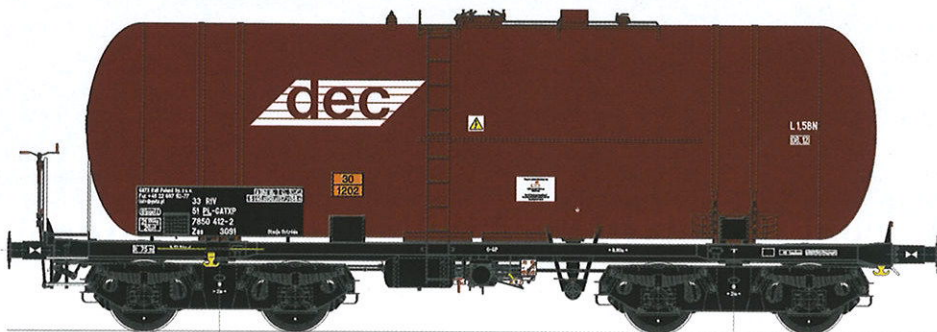
Rysunek wagonu typu 406Rb, serii Zas, nr 33 51 7850 412-2, należącego do GATX Rail Poland Sp. z o.o., w oznaczeniach PL-GATXP z epoki VI (nr kat. 58361B). Stacja mac. Ostróda; 6 REV 1008 (GATX Ostróda) 14.08.08. Należy zwrócić uwagę na fakt, że spółka GATX Rail Poland zaprzestala umieszczania oznaczeń na dennicach zbiorników, takich jak daty następnych napraw okresowych czy numery zestawów kołowych. Równocześnie ograniczono do niezbędnego minimum ilość oznaczeń eksploatacyjnych na ostoi wagonu.
