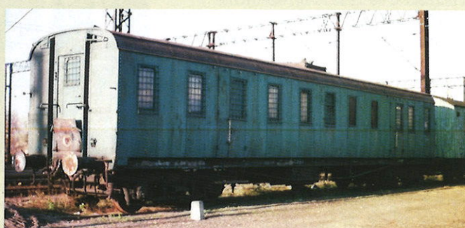
Drugi z „boczników” typu Cz 36 000 „Centoporte” (numer FS nieznan), który na kolejach FS pełnił rolę wagonu sanitarnego (także widoczne pozostałości po wejściowych drzwiach dwuskrzydłowych do transportu rannych na noszach), był oznaczony na PKP numerem 805 970 (poprz. 870 260) oraz identyczną tabliczką o miejscu i dacie przebudowy jak wagon na zdjęciu poniżej. Toruń Wsch., 4.11.1994 r. Fot. A. Etmanowicz
