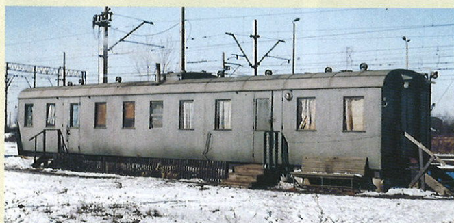
Pudło czteroosiowego „bocznika” typu Cz 36 000 „Centoporte” z nieznanym numerem kolei FS, przebudowanego na PKP na techniczno-gospodarczy z oznaczeniem 870 223 XX, sfotografowane na stacji Terespol 16.02.1994 r. Fot. A. Etmanowicz
