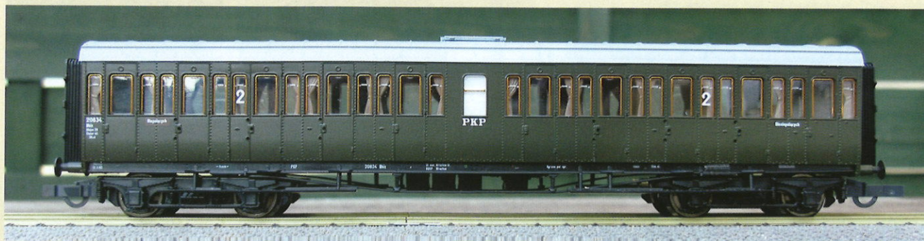
Model „bocznika” PKP typu Cz 36 000 „Centoporte” kolei FS z oznakowaniem 20 834 Bhix z doskonale odwzorowanymi dwuosiowymi wózkami typu AM, z widłowym prowadzeniem dużych prostokątnych maźnic. Wierne i bez zarzutu jest zarówno malowanie miniatury w kolorze oliwkowym, jak i doskonale, zgodnie z oryginałem znakowanie, zarówno na pudle (np. napisy „Dla palących” mają czerwone ramki), jak i na ostoży. Dobrze widoczne są duże „dwójki” umieszczone, tak jak w oryginale, na szybach okien, a w samych oknach efektownie prezentują się imitacje firanek.
