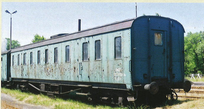
Pierwotnie wagon sanitarny kolei włoskich (numer FS nieznan), na PKP 825 995 Xho przypisany do DS Toruń Gł. (poprz. 870 261), mimo przebudowy (na ostoje prostokątne tabliczki z napisami: „PRZEBUDOWY I WYPOSAŻENIA WAGONU DOKONANO W ZAKŁADACH NAPRAWCZYCH PAROWOZÓW I WAGONÓW NR 12 W POZNANIU 1951 R.”) widoczne pozostałości po wejściowych drzwiach dwuskrzydłowych do transportu rannych na noszach. Obok jego wózek typu AM ze znajdującym się nad nim na ostoje krzyżem na okrągłej tabliczce, zachowane resztki przejść w ścianach czołowych. Toruń Gł., 22.07.1994 r. Fot. A. Etmanowicz
