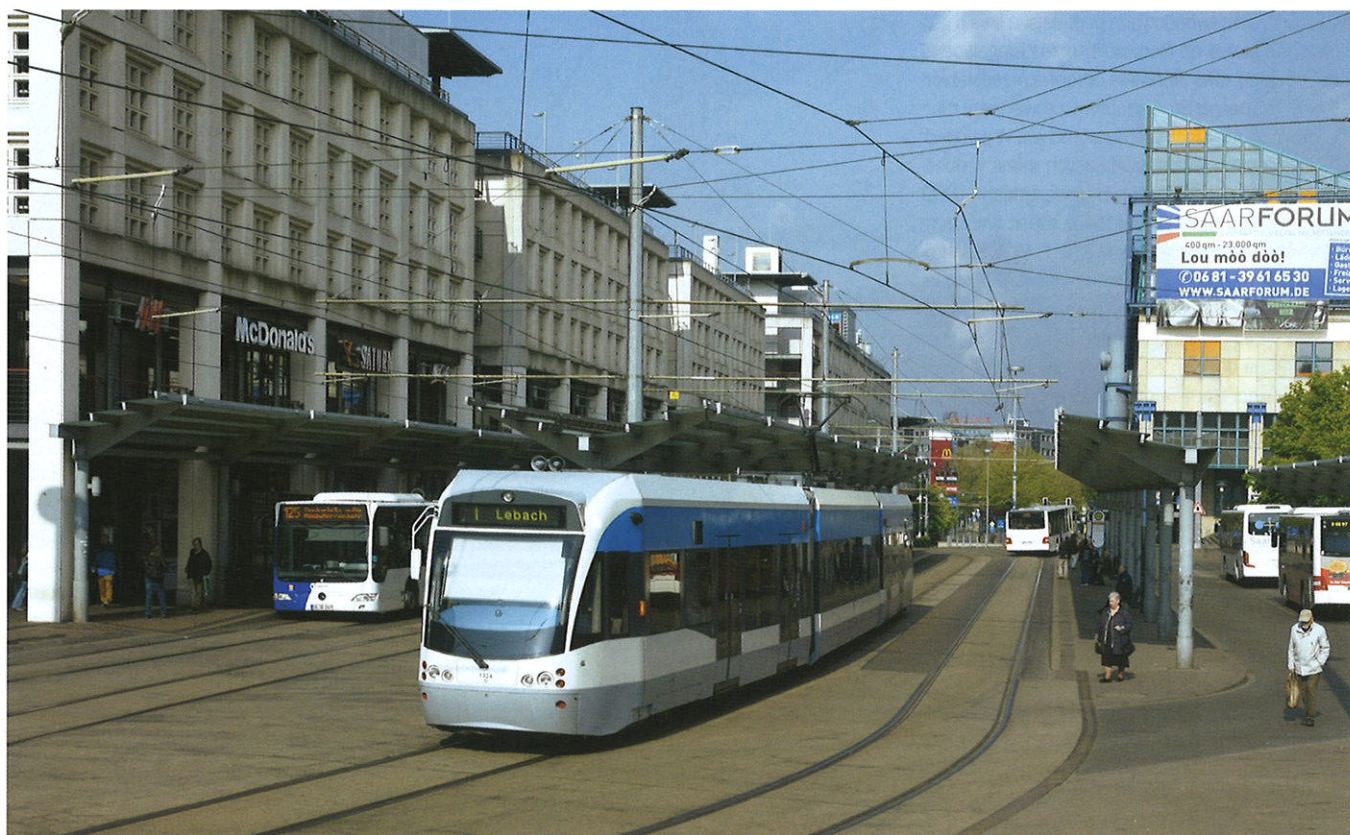
Wagon nr 1024 odjeżdża z dworca przesiadkowego komunikacji miejskiej przy głównym dworcu kolejowym w Saarbrücken w kierunku Lebach. W ruchu liniowym Stadtbahn Saarbrücken wykorzystuje dwa wewnętrzne tory, dwa zewnętrzne umożliwiają odjazd tramwajów z peronów autobusowych. Tak rozbudowany układ torowy stanowi przyszłościową rezerwę, ułatwia manewry podczas zmian w organizacji ruchu i pozwala na uruchamianie pociągów specjalnych; 29.04.2017 r.
