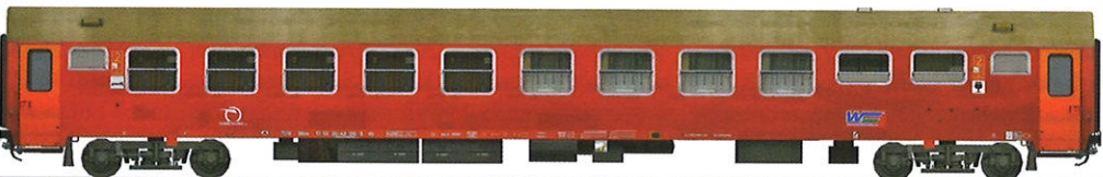
Wagon osobowy klasy 2 z miejscami do leżenia i przedziałem bufetowym o numerze 51 56 85-40 015-9 serii BRcm w barwach kolei słowackich ZSSK stosowanych przed 2005 rokiem.
