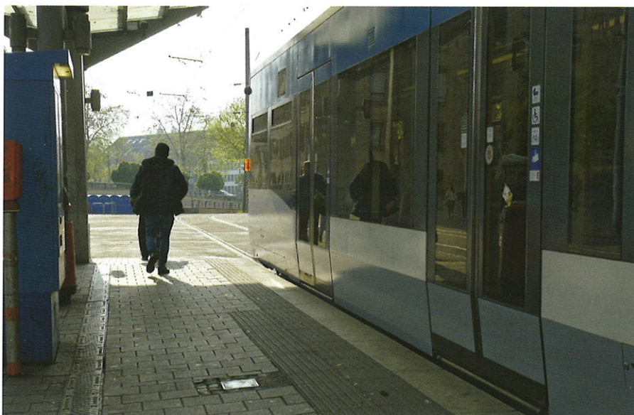
Zarówno projektanci, jak i wykonawcy infrastruktury przystankowej zadbali o możliwie dokładne dopasowanie poziomu platform peronów przystankowych do wysokości wejść i szerokości tramwajów, co znakomicie zwiększa dostępność dla osób niepełnosprawnych, wózków i skraca czas wymiany pasażerów. Dworzec główny w Saarbrücken, 29.04.2017 r.
