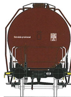
Rysunek wagonu typu 406Rb, serii Zas, nr 33 51 7859 535-1, należącego do GATX Rail Poland Sp. z o.o., w oznaczeniach PL-GATXP z epoki VI (nr kat. 58361A). Stacja mac. Ostróda; 6 REV 918 (ZNTK Olawa) 27.02.08. Przykład nieco wcześniejszego znakowania wagonów GATX Rail Poland, jeszcze z pełną nazwą i danymi teleadresowymi właściciela wagonu umieszczonymi na zbiorniku, numerami zestawów kołowych i napisami „Ostrożnie przetaczać” na dennicach zbiornika, jednak już bez napisów dot. następnych napraw okresowych wagonu.
