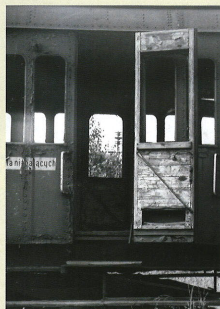
Wrak jednego z ostatnich na PKP włoskich czteroosiowych „boczników” Cz 36 000 „Centoporte” oraz jego fragmenty: ściana czołowa z zachowanym przejściem międzywagonowym i część ściany bocznej z drzwiami wagonu 50 51 29-20 161-0 Bix, sfotografowanego 10.06.1983 r. na stacji Zabrzeg Czarnolesie. Jako FS 36 491 po 1945 roku znalazł się na PKP i został oznaczony numerem 019 866, zachowując osłonięte harmoniami, oryginalne przejścia w ścianach czołowych.
