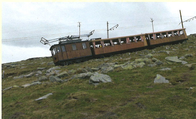
Lokomotywa nr 1 (SLM 2233/1912) kolejki Chemin de Fer de la Rhune rozpoczyna zjazd z górnej stacji La Rhune (910 m n.p.m.) trasą o spadkach dochodzących do 250‰ i długości 4,2 km do dolnej stacji Col de Saint-Ignace (169 m n.p.m.). Kolejka zasilana jest prądem trójfazowym 3 kV/50 Hz; 24.04.2018 r. Fot. M. Knappe
