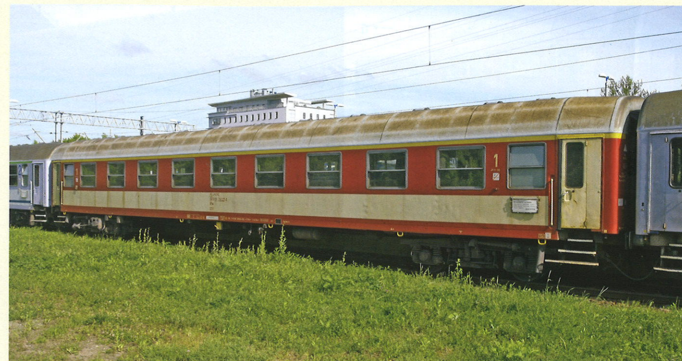
Wagon 1 klasy typu 112Ag z oznakowaniem PL-PKP IC 50 51 19-78 221-5 A 0 ou ze stacji Przemyśl, zdjęcie od strony przedziałów; dobrze widoczne charakterystyczne cechy tej odmiany, takie jak prostokątne okna odpowiadające fabrycznym, gładki dach oraz trzy stopnie pod drzwiami wejściowymi. Fotografię wykonano 1.06.2014 r. na stacji Warszawa Gdańska w składzie pociągu TLK 51108 „Niemen” z Bydgoszczy Gł. do Białegostoku. Ten wagon stał się pierwowzorem dla modelu o nr kat. 2113220.
