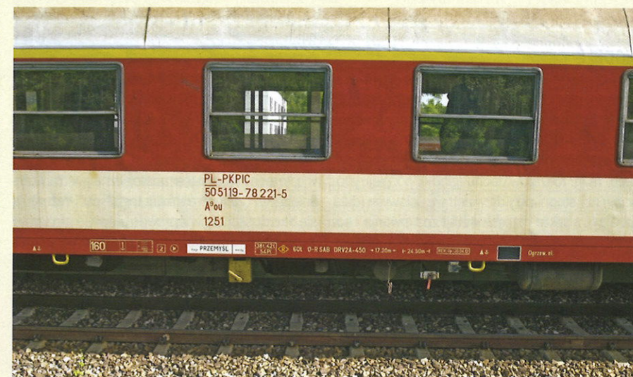
Fotografia środkowej części wagonu 50 51 19-78 221-5 A 0 ou wykonana od strony przedziałów pokazuje jego charakterystyczne znakowanie na środku pasa podokienkowego w układzie „pionowym” w czterech rzędach oraz napisy na tym dolnym pasie, takie jak: nazwy stacji (Przemyśl - pisana drukowanymi literami) i przewoźnika (Intercity), oba w białych ramach oraz miejsce i datę wykonania rewizji okresowej (Op - Opole, 30.04.12). Warszawa Gdańska, pociąg TLK 51108 „Niemen” z Bydgoszczy Gł. do Białegostoku, 1.06.2014 r.
