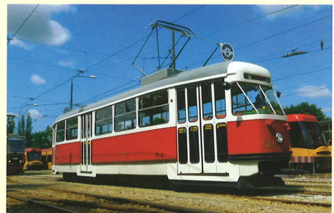
Warszawa. Tak prezentuje się obecnie wagon 503. Najbardziej rzucające się w oczy różnice to tzw. mały film, dzielona szyba czołowa i pantograf nożycowy; 19.05.2018 r. Fot. D. Walczak
