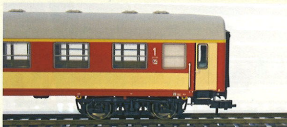
Wózki typu 4ANc zachwycają dokładnością i precyzją odwzorowania, z lewej zdjęcie końcowego fragmentu z wózkiem typu 4ANc bez prądnicy, z prawej z prądnicą napędzaną wałem kardana.
