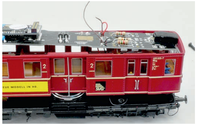
Beim Wiederausammenbau ist genau auf die Kabelführung zu achten.
