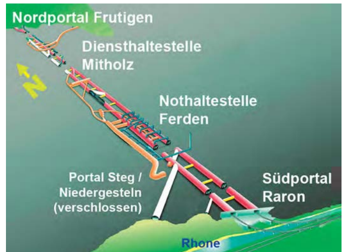
Die heute befahrbaren Basistunnelröhren (rot) mit den Verbindungs- und Fensterstollen (orange/gelb). ILLUSTRATION: BLS ALPTRANSIT AG
