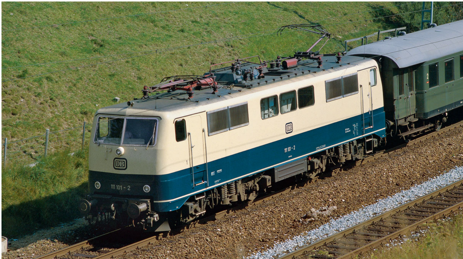
Die 111 101 aus der zweiten Bauserie wurde von Henschel gebaut und von BBC elektrisch ausgerüstet (bei Traunstein, September 1980). FOTOS: A. RITZ (2)
