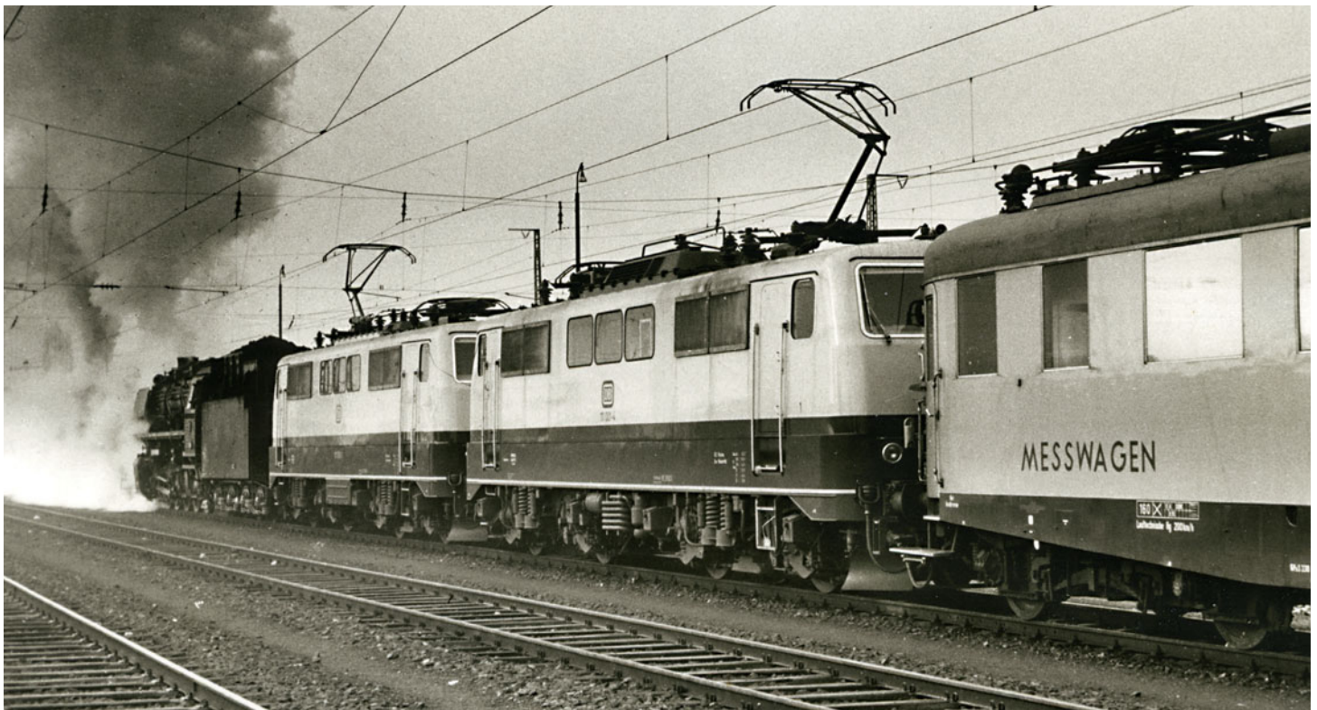
Im Januar 1976 wurden auf der Strecke Regensburg–Passau die Leistungen der 111 007 gemessen (auf diesem Foto nicht zu sehen). Die mit Riggimbach-Gegendruckbremsen ausgerüsteten Bremsloks 044 404 und 044 427 und zwei 111er waren mit von der Partie. FOTO: DB-PRESSEDIENST
