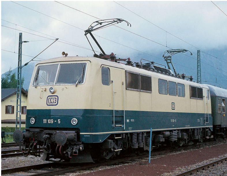
Mehrere 111er dienten als Erprobungsträger für neue Stromabnehmertypen. Der Lokführer der 111 109 war am 17. Mai 1981 in Ruhpolding so freundlich, für den Fotografen beide Stromabnehmer aufzubügeln (links ein SBS 65, rechts ein verbesserter WBL 79). Nach einem Unfall am 27. August 1981 wurde die Lok als erste 111 ausgemustert. FOTO: CH. KIRCHNER
