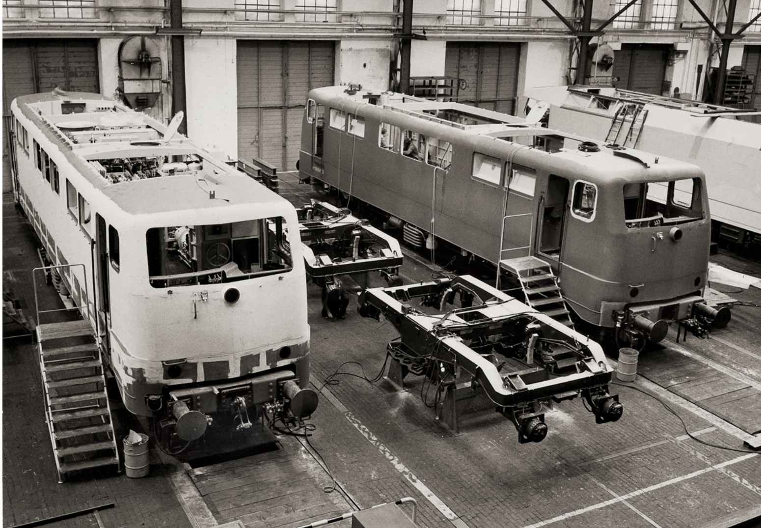
Im Sommer 1978 befanden sich die 111 111 bis 122 in der Endmontage. Die Drehgestellteile sind für die 120 001 bestimmt. WERKFOTOS KRAUSS-MAFFEI (3)
