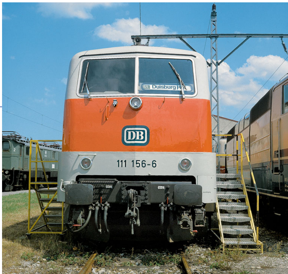
Die S-Bahn-111er erhielten hinter der linken Frontscheibe zusätzlich einen Zugzielanzeiger.
