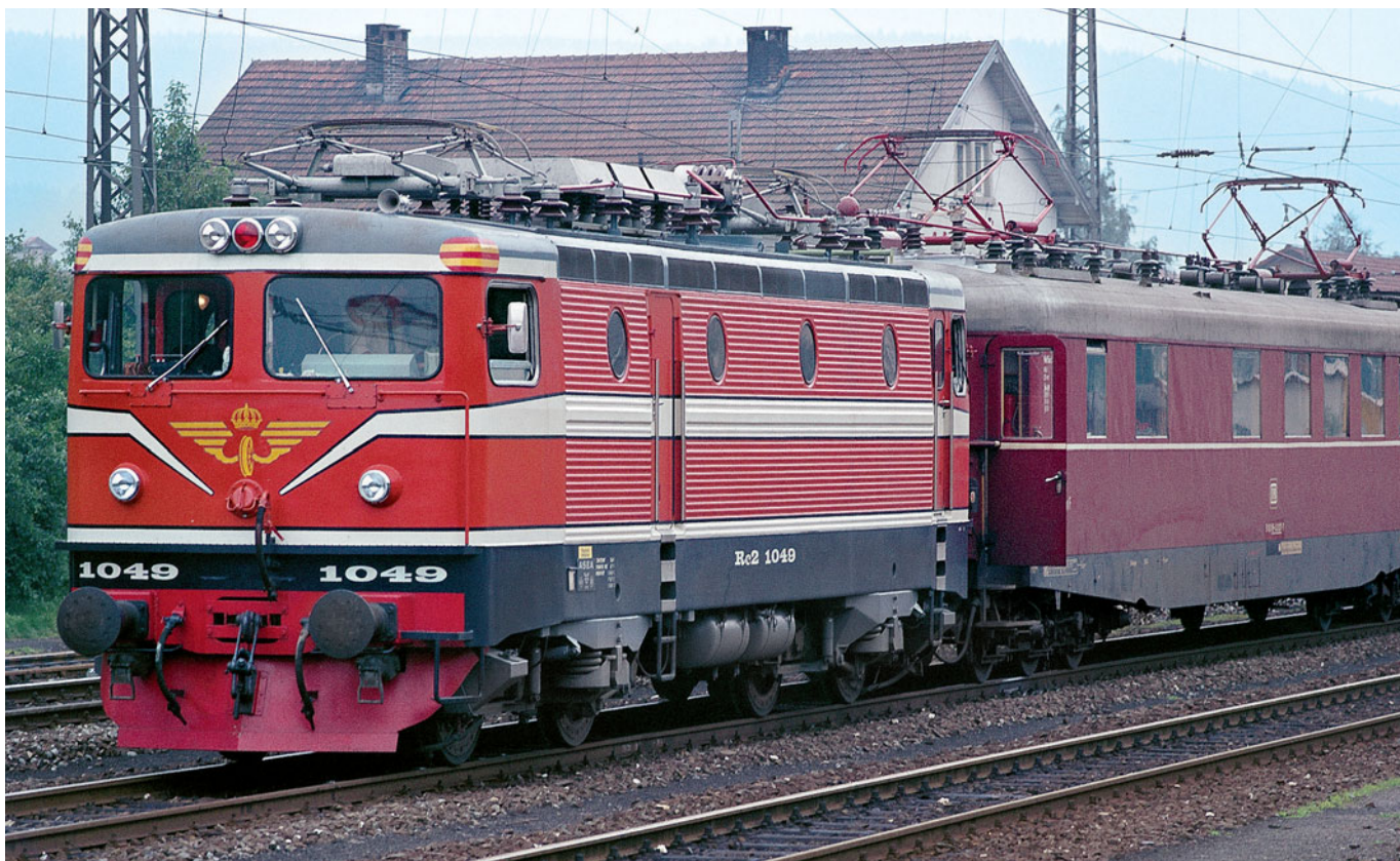
Messfahrten im Juli 1970 mit der schwedischen Thyristor-Lok Rc2 Nr.1049 auf der Strecke Bamberg–Ludwigsstadt (Aufnahme in Kronach). FOTO: J. NELKENBRECHER
