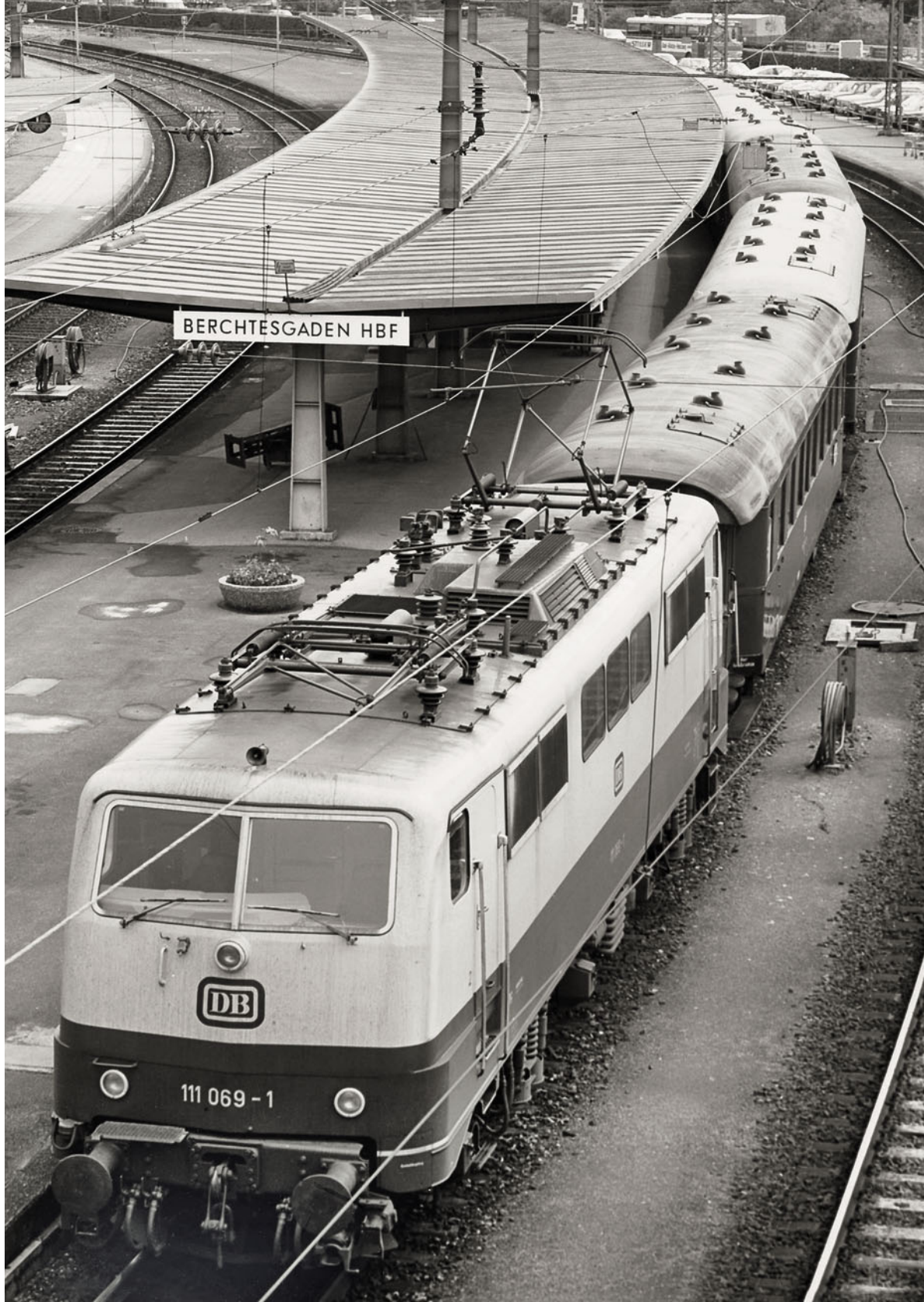
Die mit Scherenstromabnehmern des Typs DBS 54 ausgestattete 111 069 hat um 1978 in Berchtesgaden Hbf Vorkriegs-Eilzugwagen am Haken.
