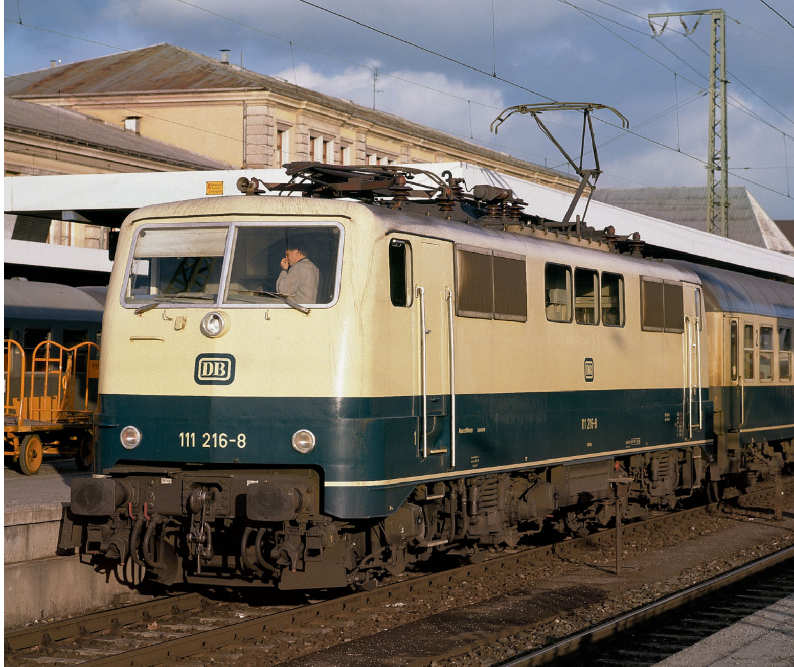
Die tiefstehende Abendsonne leuchtet im März 1987 im Nürnberger Hauptbahnhof die Drehgestelle der 111 216 ausgezeichnet aus. Wie alle 111er ab 111 147 besitzt die Lok ab Werk rechteckige Pufferteller. FOTO: G. DILLIG
