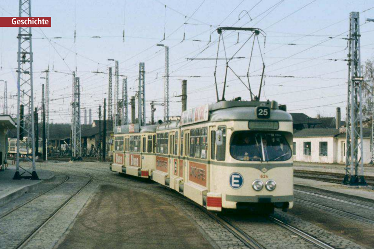
Sechssachs-Tw 624 am 12. November 1968 in Hedderheim mit Verbreiterungen und Klappstufen für den U-Bahn-Einsatz. Die Fahrzeuge wurden in dieser Ausrüstung als Typ Mv/mv (V für „Vorortbahn“) bezeichnet. 1978 erfolgte der Rückbau zu „normalen“ Straßenbahn-Fahrzeugen WILHELM ECKERT, SLG. WOLFGANG MEIER (2)
