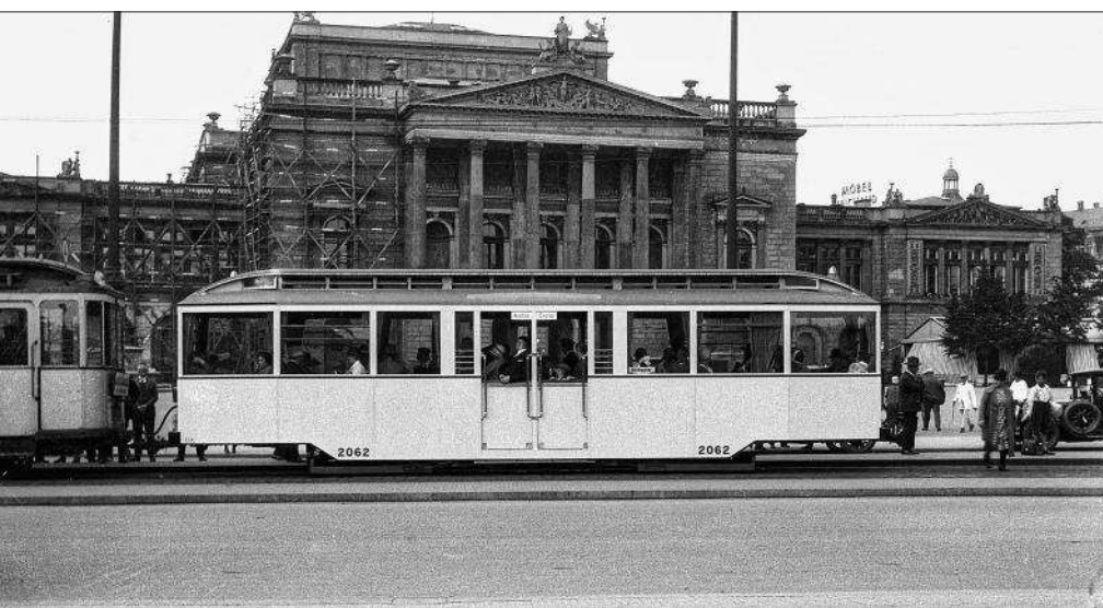
Seitenansicht eines Niederflurbeiwagens der Serie von 100 Einheiten der Leipziger Straßenbahn in den 1930er Jahren. Typisch waren die halbhohen Türen, welche in der wärmeren Jahreszeit für eine gute Belüftung sorgten
