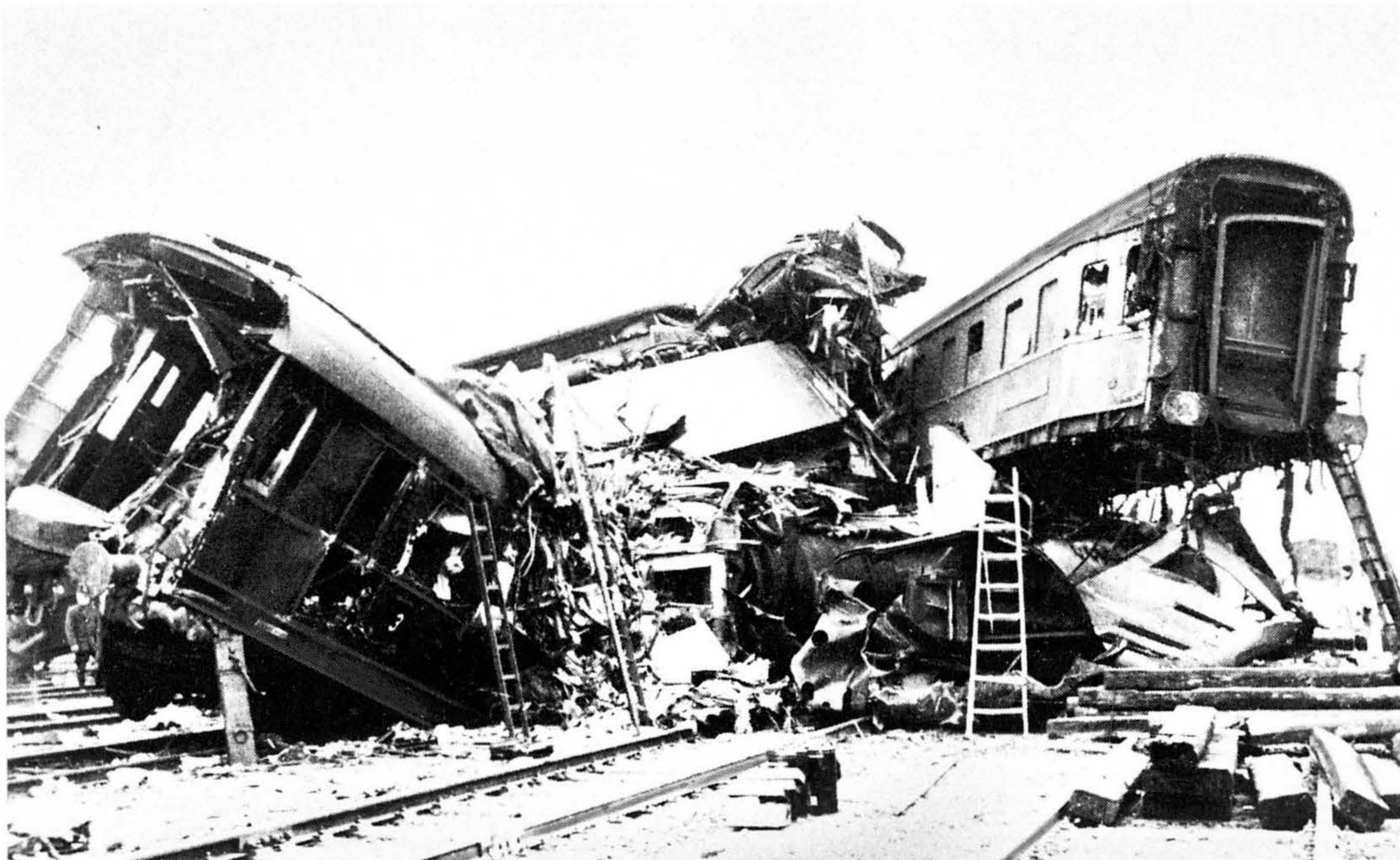
Bild 49 Der Genthiner Trümmerberg aus Richtung Burg gesehen: Mitte unten die Lokomotive des D 180 01 158, auf ihr deren Tender. Rechts unten der Gepäckwagen des D 10, darüber der vorletzte Schlafwagen des D 10, darunter der Gepäckwagen des D 10, der nach dem Schlafwagen lief. Links der Sitzwagen, vermutlich an fünfter Stelle, vom Schluß aus gezählt, im D 10 gelaufen. Foto: StA Magdeburg
