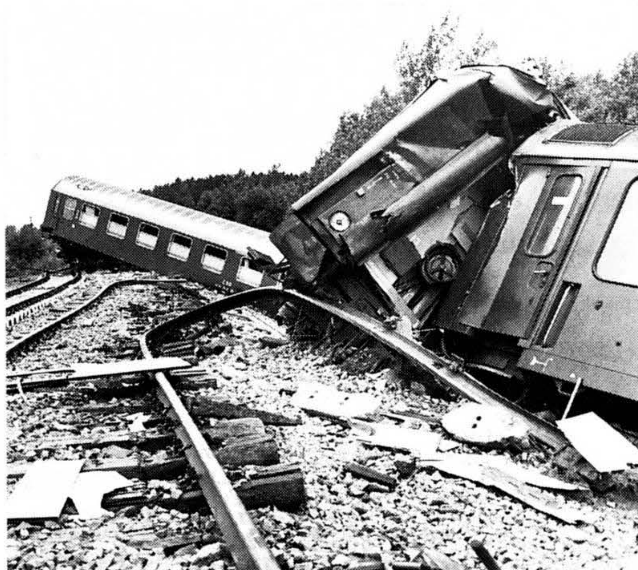
Bild 112 Der Lokomotivführer des D 523 Rostock–Berlin fuhr am 6. Juli 1982 zwischen Grabowhöfe und Vielitz zu schnell über eine Langsamfahrstelle. Der Zug entgleiste. Foto: ADN-ZB/Stein
