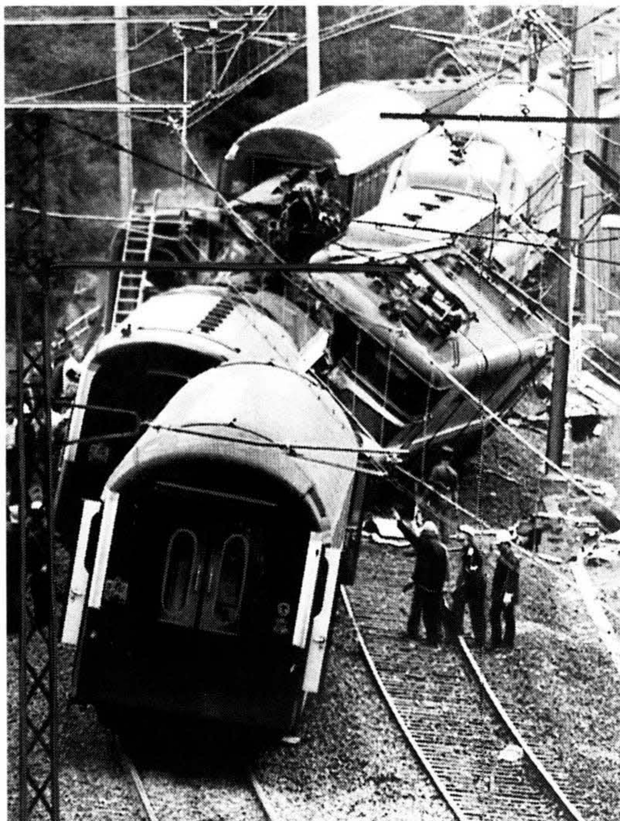
Bild 110 Im Bahnhof Argenton-Sur-Creuse entgleist am 30. August 1985 der Liegewagenzug Paris–Port Bou, weil der Lokomotivführer zu schnell über eine Langsamfahrstelle fuhr, und in diesem Augenblick rast ein Postzug in die Wagen. Foto: ADN-ZB-AFP
