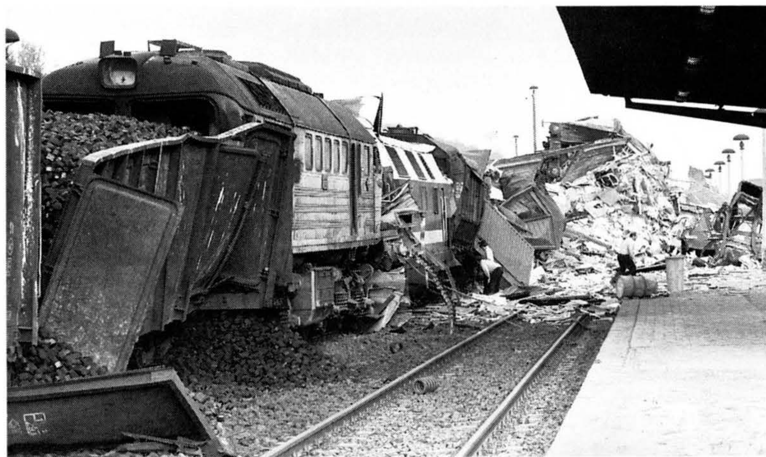
Bild 95 Bahnhof Bad Köstritz am 4. Juli 1983: Der Lokomotivführer mißachtete das Halt zeigende Einfahrersignal, worauf er mit dem im Bahnhof haltenden Güterzug zusammenstieß.
