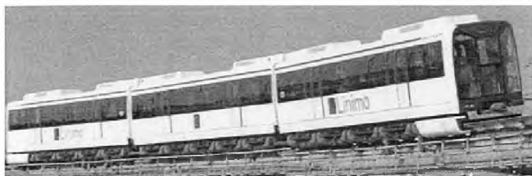
Рис. 8.3.1. Городская транспортная система с магнитным подвесом и ЛАД
