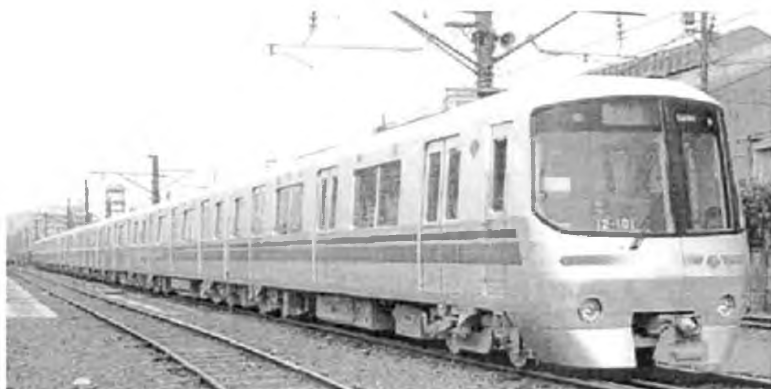
Рис. 8.3.18. Поезд серии 12-000 с линейным асинхронным двигателем для метро г. Токио
