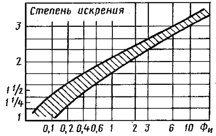
Рис. 6.1.12. Зависимость степени искрения от фактора искрения \Phi_{и}
