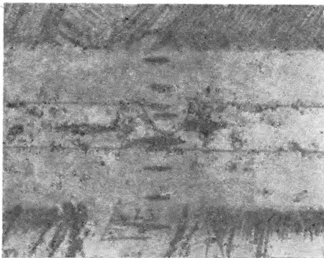
Рис. 56. Микроструктура шва при пайке титана чистым серебром; \times 500
