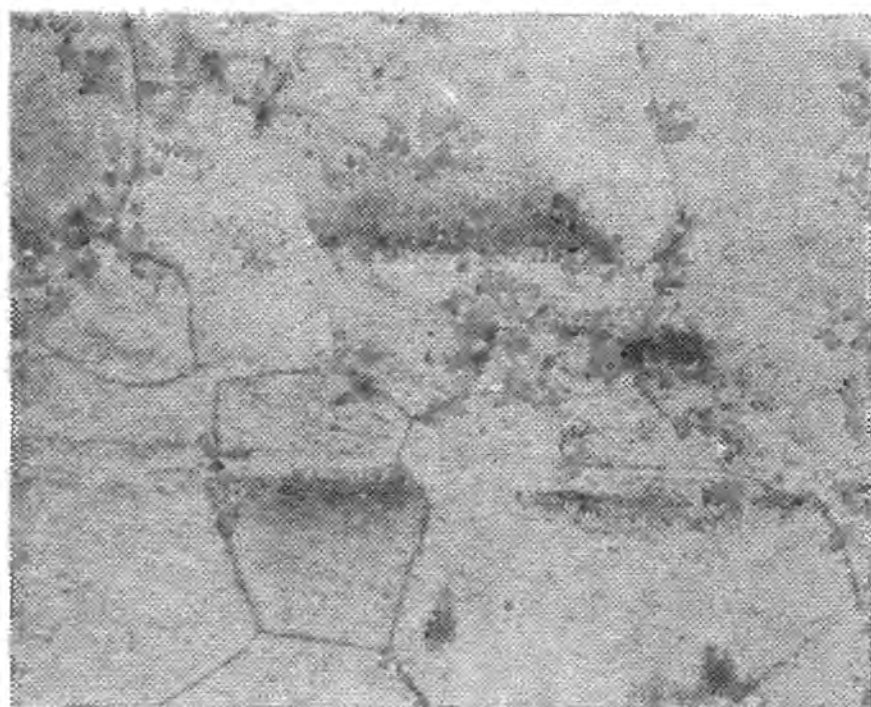
Рис. 59. Микроструктура шва при пайке никеля медью в вакууме (по А. С. Ека-товой); \times 200
