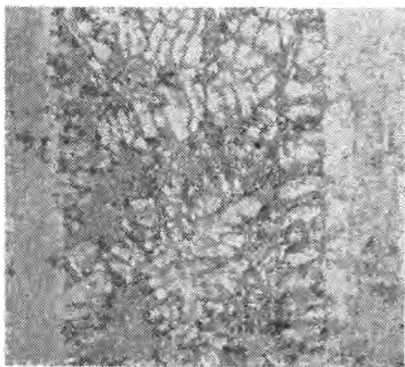
Рис. 60. Микроструктура шва при пайке алюминия припоем 34А; \times 150
