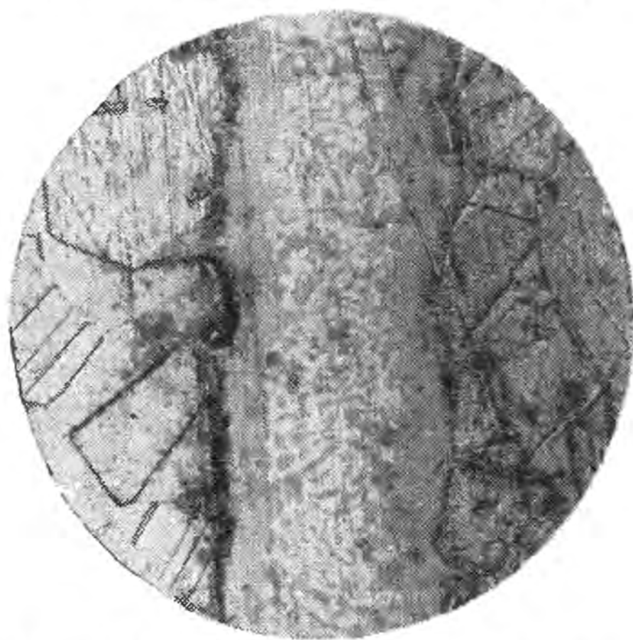
Рис. 127. Микроструктура шва при пайке меди серебряным припоем, содержащим палладий (по Л. Л. Гржимальскому); \times 200
