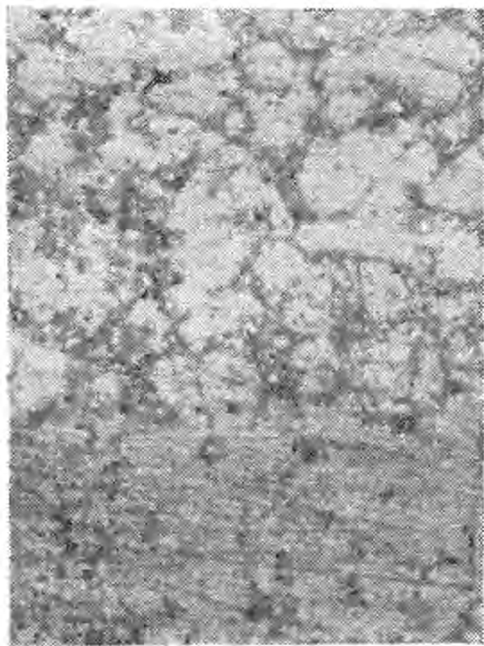
Рис. 65. Микроструктура шва по границе основной металл — припой при пайке алюминия припоем марки 34А; \times 200
