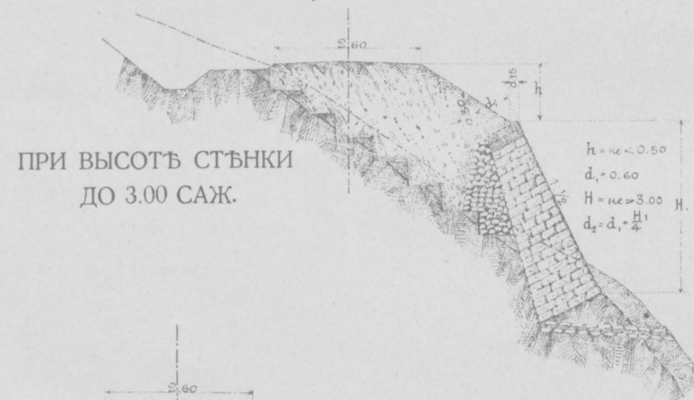
Типы подпорныхъ стѣнокъ. изъ сухой кладки.
