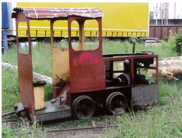
Przebudowana lokomotywa górnicza typu „Karlik”. 09.06.2011 r. Fot. Tomek Jankowski
