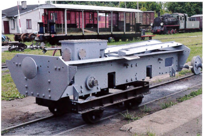
Podwozie lokomotywy 2WLS40 po gruntownym oczyszczeniu zostało pokryte farbą podkładową, 25.06.2014 r.
