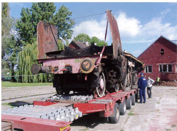
Podwozie parowozu Ok1-266 podczas rozładunku na terenie parowozowni w Skierniewicach. 27.09.2014 r. Fot. Paweł Mierosławski
