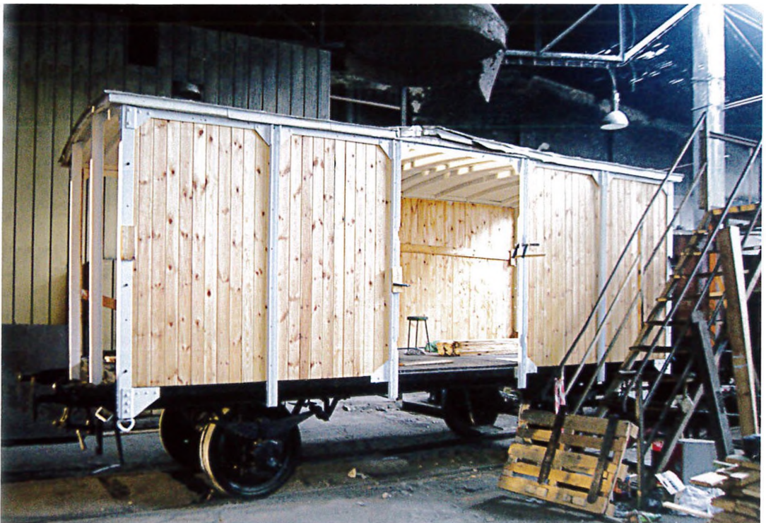
Wagon piwiarka z zamontowanymi nowymi deskami. 10.01.2015 r.
