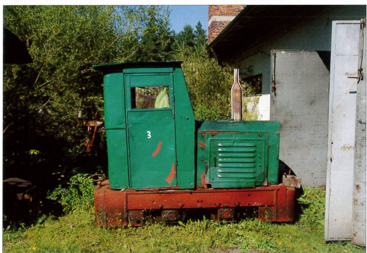
Lokomotywa nr 3, jest to zmodernizowana maszyna typu Ns1 nr fabr. 247316/1956 r. 27.08.2016 r.
