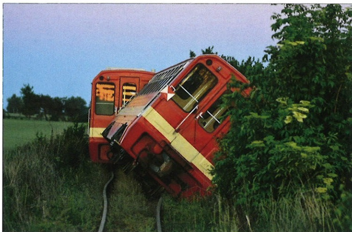
Wykolejenie między Żelazkowem a Niechanowem, spowodowane kradzieżą elementów łącznych. 04.06.2015 r.
