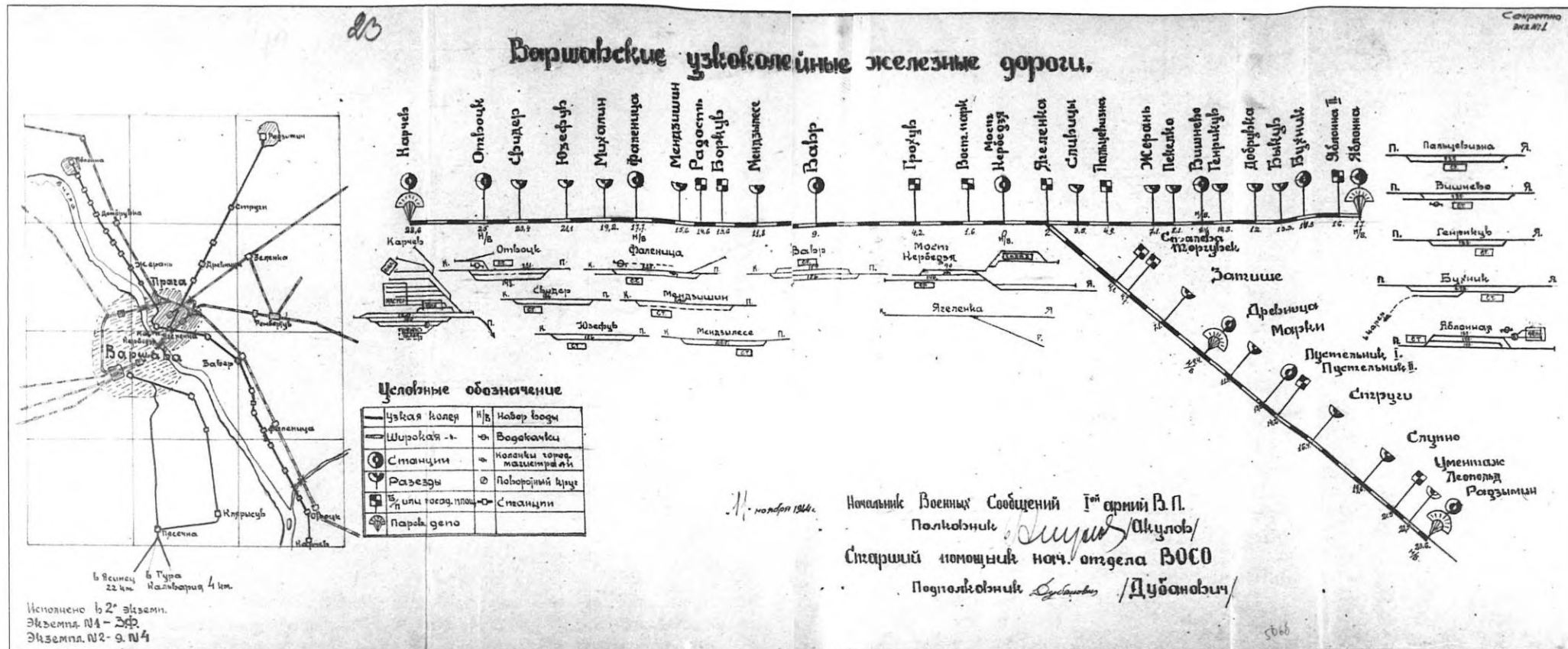
Plan schematyczny kolei wąskotorowych wschodniego brzegu Wisły wraz ze schematycznymi układami torowymi.
