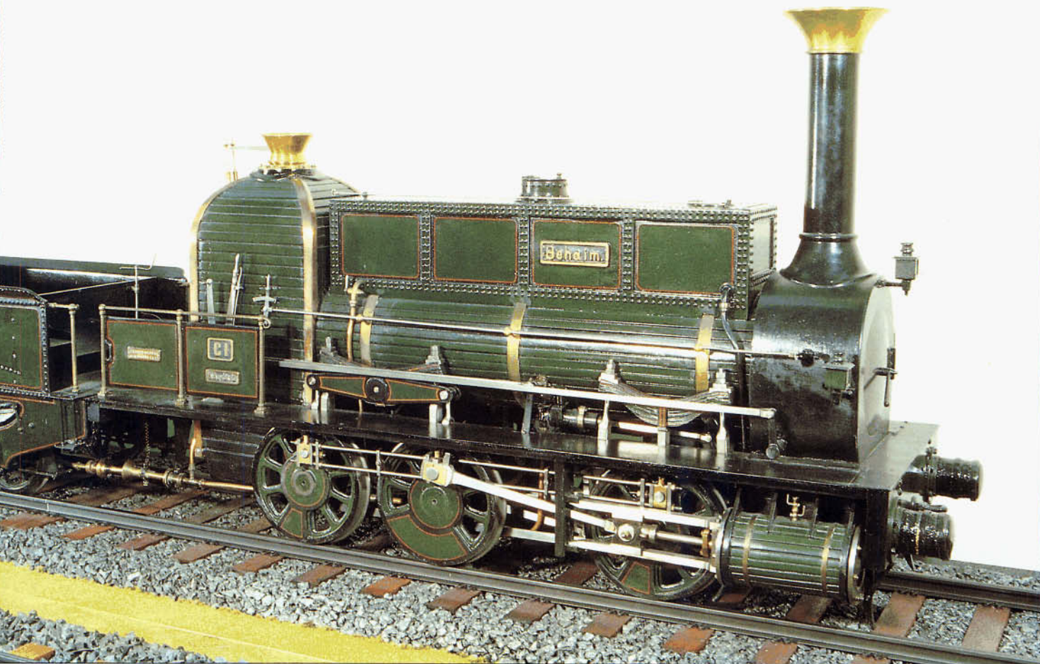
Bild 158: Seitenansicht der Lok C I BEHAIM und ihres Tenders im Lieferzustand – als 1:10-Modell im Verkehrsmuseum Nürnberg zu bewundern. Abb. 155 bis 158: Merker Verlag im Verkehrsmuseum Nürnberg
