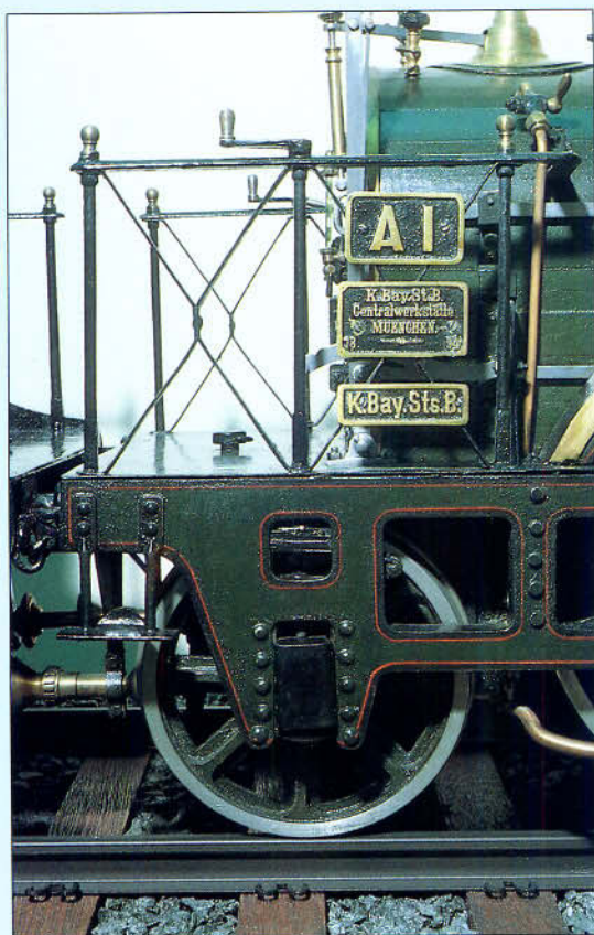
Bilder 21 bis 23: Im Verkehrsmuseum in Nürnberg befindet sich das 1:10-Modell der A I BAVARIA, das 1894 in der CW München gebaut worden ist. Links hintere Laufachse und Führerstand, oben Triebwerk und rechts Steuerung der BAVARIA.
