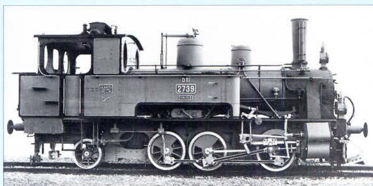
Bilder 68 und 69: Die zur letzten Maffei-Lieferung gehörende 2739 ist bereits ab Werk mit einem vorderen Schneeräumer ausgerüstet. Abb.: Werkfoto Krauss-Maffei
