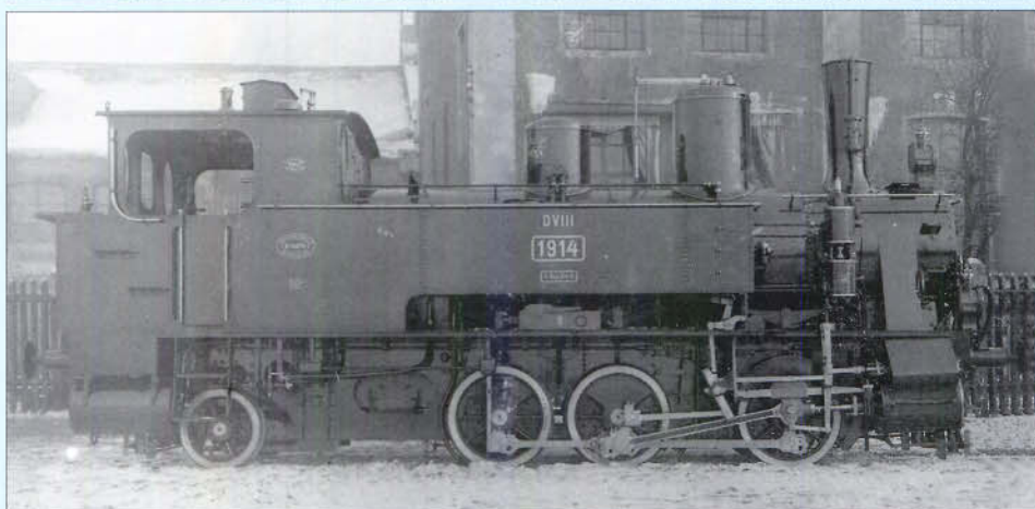
Bild 18: Die geänderte Ausführung von Kesselaufbauten und Bremse bei den ab 1898 gelieferten Maschinen ist hier bei der 1909 gut zu sehen. Abb.: Werkfoto Krauss-Maffei
