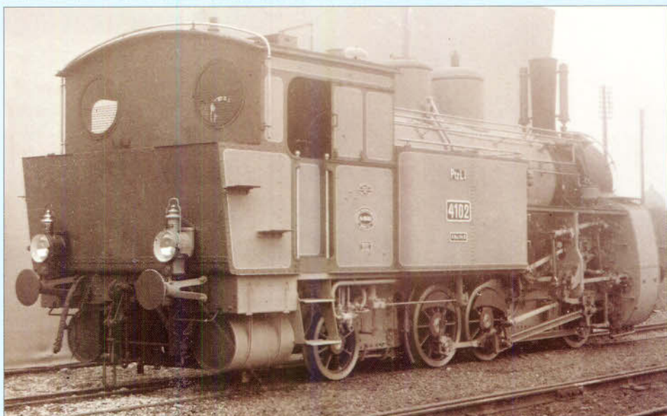
Bild 284: Im August 1912 wartet 4102 auf die Ablieferung. Das Zahnradtriebwerk bedingt die für Lokbahnlokomotiven hohe Kessellage. Abb.: Sammlung Dr. Scheingraber
