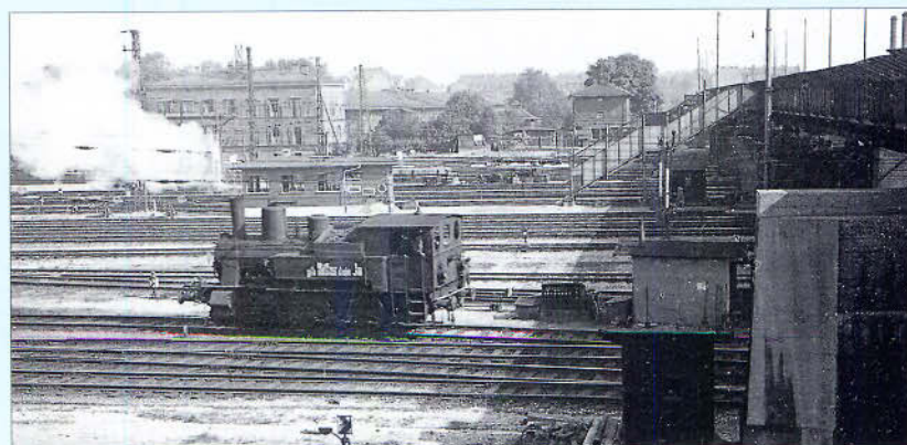
Bild 206: Bei der 89 642 wurde zur Vergrößerung des Kohlenvorrats lediglich ein Stützbrett am Wasserkasten befestigt. Abb. 204 und 206: H. Maey
