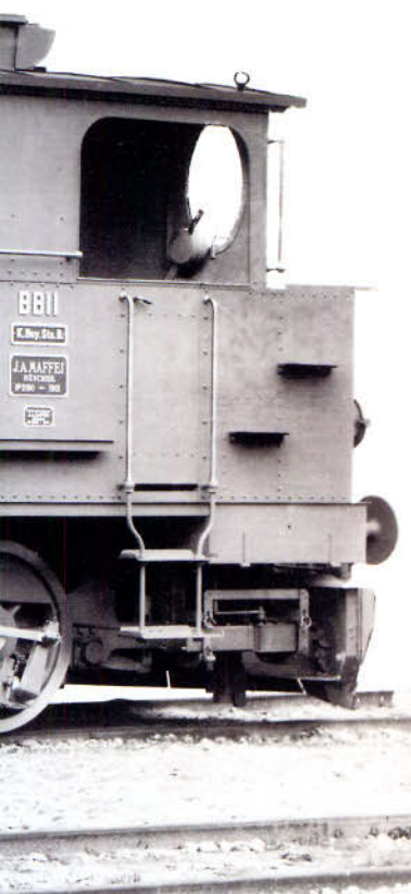
Bild 158: Die 1901 gelieferte BB II 2525 war ab Werk mit einem voluminösen vorderen Schneeräumer ausgerüstet.
