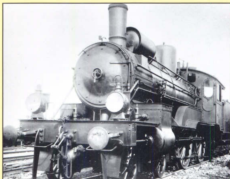
Bild 18: Die sehr schräge Aufnahme der (S 5) Hannover 515 läßt deutlich den durchgehenden Zylinderblock erkennen. (Die Niederdruckzylinder sind außen angeordnet und mit dem zugehörigen Hochdruckzylinder in einem Gußstück zusammengefaßt.) Alle Abbildungen (soweit nicht anders angegeben): Sig. Dr. Scheingraber
