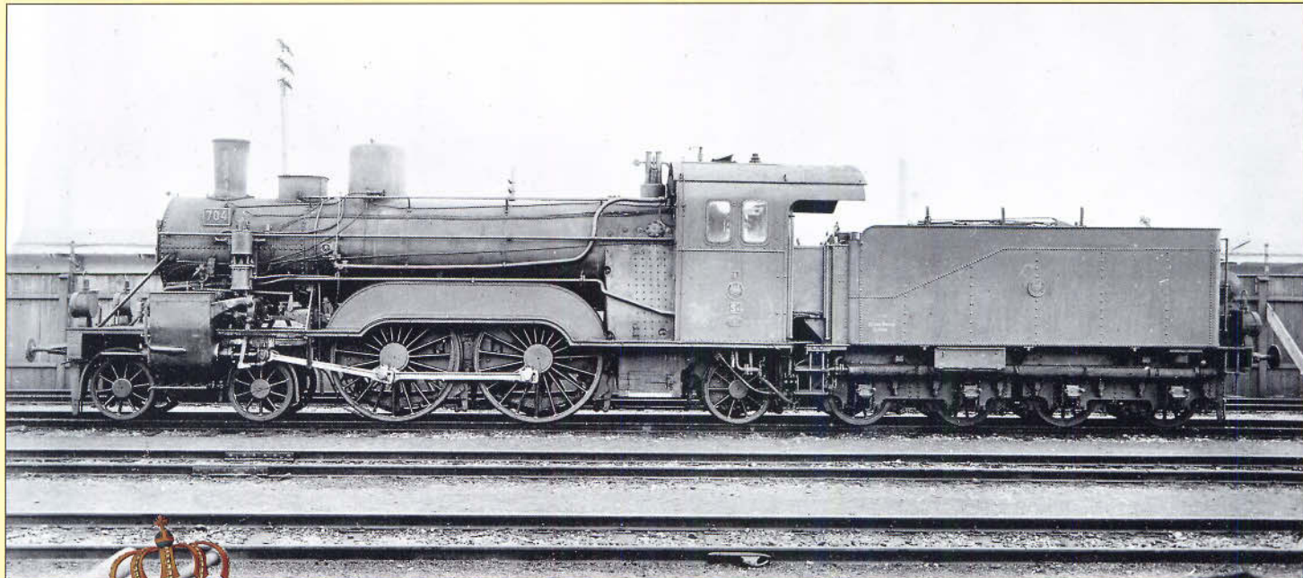
Bild 1: Die (S 7) Stettin 704 wurde 1906 von Hanomag gebaut (Fabrik-Nr. 4518). Sie erhielt 1910 versuchsweise den gerade erst von Schmidt entwickelten Kleinrohrüberhitzer.
