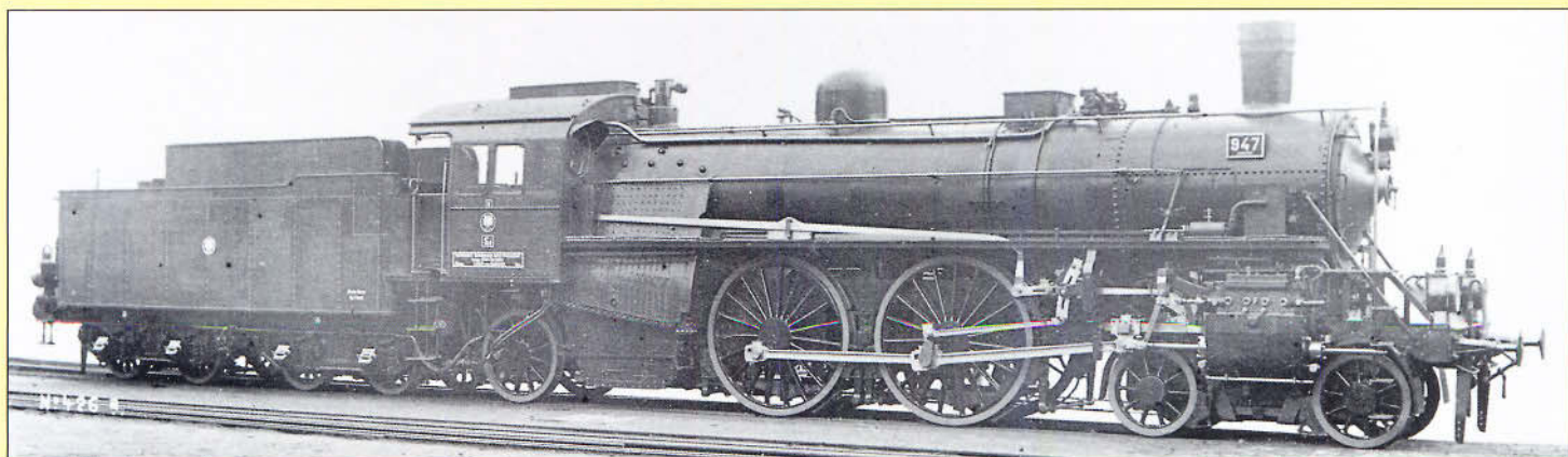
Bild 12: Die (S 9) Hannover 947, die anstelle der Kolbenschieber bei den Hochdruckzylindern die Ventilsteuerung Bauart Lentz hatte. Sie war mit der Anfahrvorrichtung Bauart Ranafier ausgerüstet.
