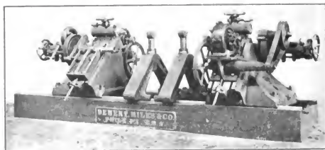
Fig. 5000. Quartering Machine. Niles-Bement-Pond Co.
