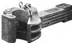
Fig. 3966. Gould Tender Coupler.
