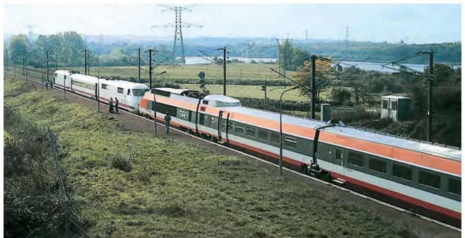
Und es geht doch: Die konkurrierenden Zugsysteme TGV und ICE in „inniger Verbundenheit“ auf Frankreichs Gleisen. Die damaligen Versuche dienten dem Nachweis, dass ein Fahrzeug mit 20 t Achslast und optimierter Fahrwerksauslegung (ICE) die Fahrbahn nicht mehr beansprucht als ein Fahrzeug mit 17 t Achslast (TGV). Dies wurde durch Messungen am Gleis eindrucksvoll bestätigt.
