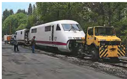
Anders als beim ICE 1 sollten die ICE-2-Züge auch betrieblich gekuppelt werden. Zur Erprobung wurden zunächst die ICE-V-Triebköpfe entsprechend hergerichtet (bei Krupp, 19. April 1994). Darunter im Mai 1994 erste „Gehversuche“ der umgebauten Triebköpfe. FOTOS: ULRICH BUDDE, MICHAEL HUBRICH
