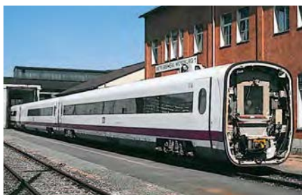
Im Juli 1988 stand ein Triebkopf für längere Zeit nicht zur Verfügung. Um die Versuche trotzdem fortsetzen zu können, wurde 810 003 behelfsweise mit einem Notsteuerstand versehen (Bw Würzburg, 11. Juli 1988).
