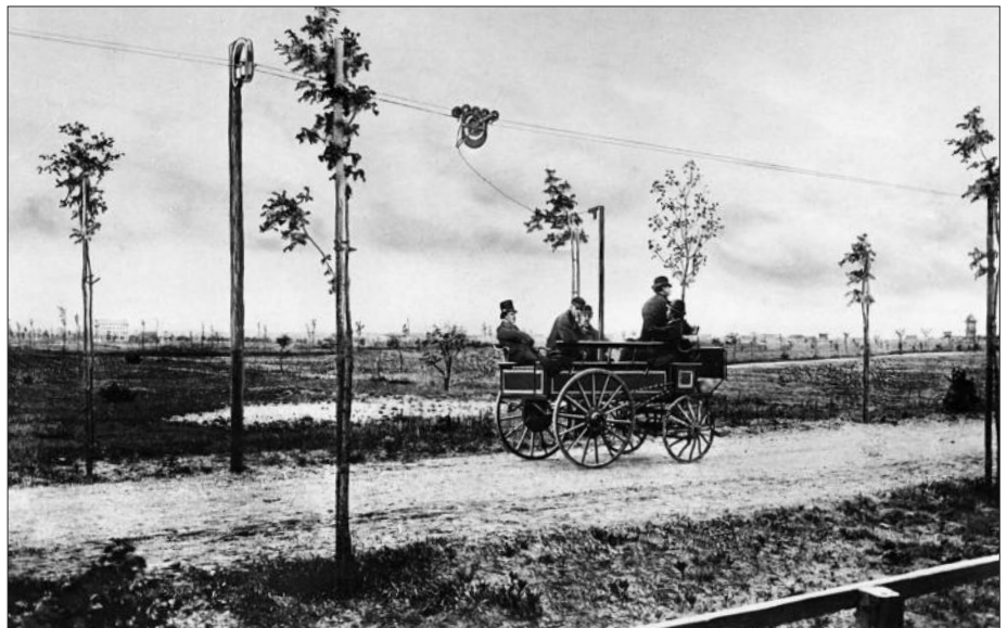
Der erste Obus der Welt war ein offener Zweiaxser, der auf einer kurzen Demonstrationsstrecke bei Berlin-Halensee pendelte. Der Betrieb im Sommer 1882 dauerte aber nur wenige Monate
