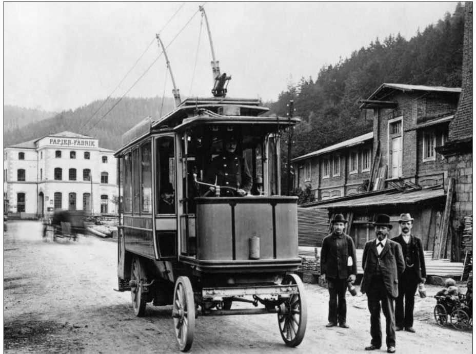
Die Bielathalbahn bei Königstein an der Elbe war die zweite Obus-Strecke Deutschlands. Sie war ein Pionierprojekt Max Schiemanns, der an dieser Strecke die Funktionsfähigkeit seines Zweistangenkontakts zur Stromabnahme bewies
