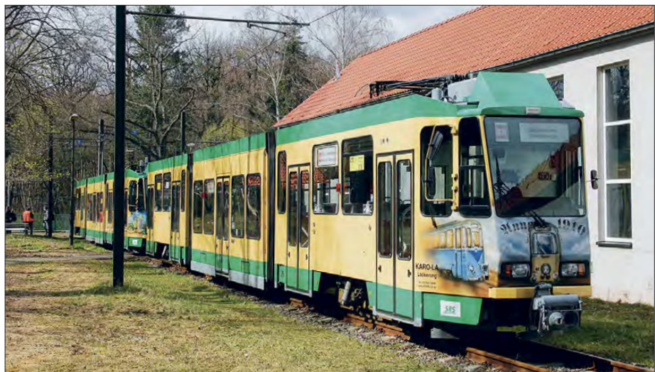
Die KTNF6, die früher in Cottbus fuhren, sind bei der SRS mit Stadt- und Straßenbahnmotiven bemalt worden. Sie bieten zumindest im Mittelteil eine niederflurige Einstiegsmöglichkeit. Drei Fahrzeuge sind vorhanden, ein viertes soll bald in Betrieb genommen werden CHRISTIAN LÜCKER (4)
