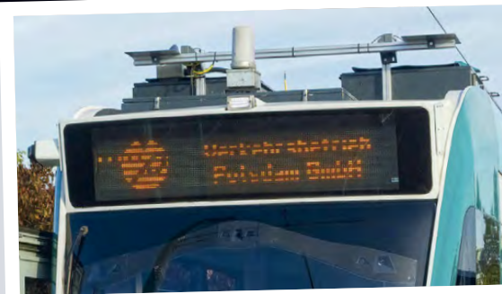
Eine provisorische GPS-Antenne auf dem Dach des Combino 400 ermöglicht die präzise Standortbestimmung
