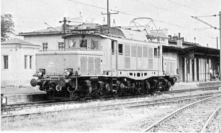
1020.47 in Hütteldorf als Lz 246 (30. 7. 1954). Die 3 Nachkriegsbauten wurden zum Einbau des elektrischen Teils in die HW Linz gebracht und kamen zur Endfertigung wieder in die Lofag nach Floridsdorf.
