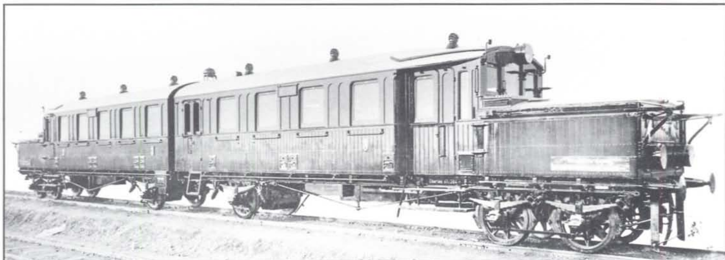
Bild 3: Der AT 393/394 war mit einer Holzverkleidung versehen und führte nur die 3. Wagenklasse.
