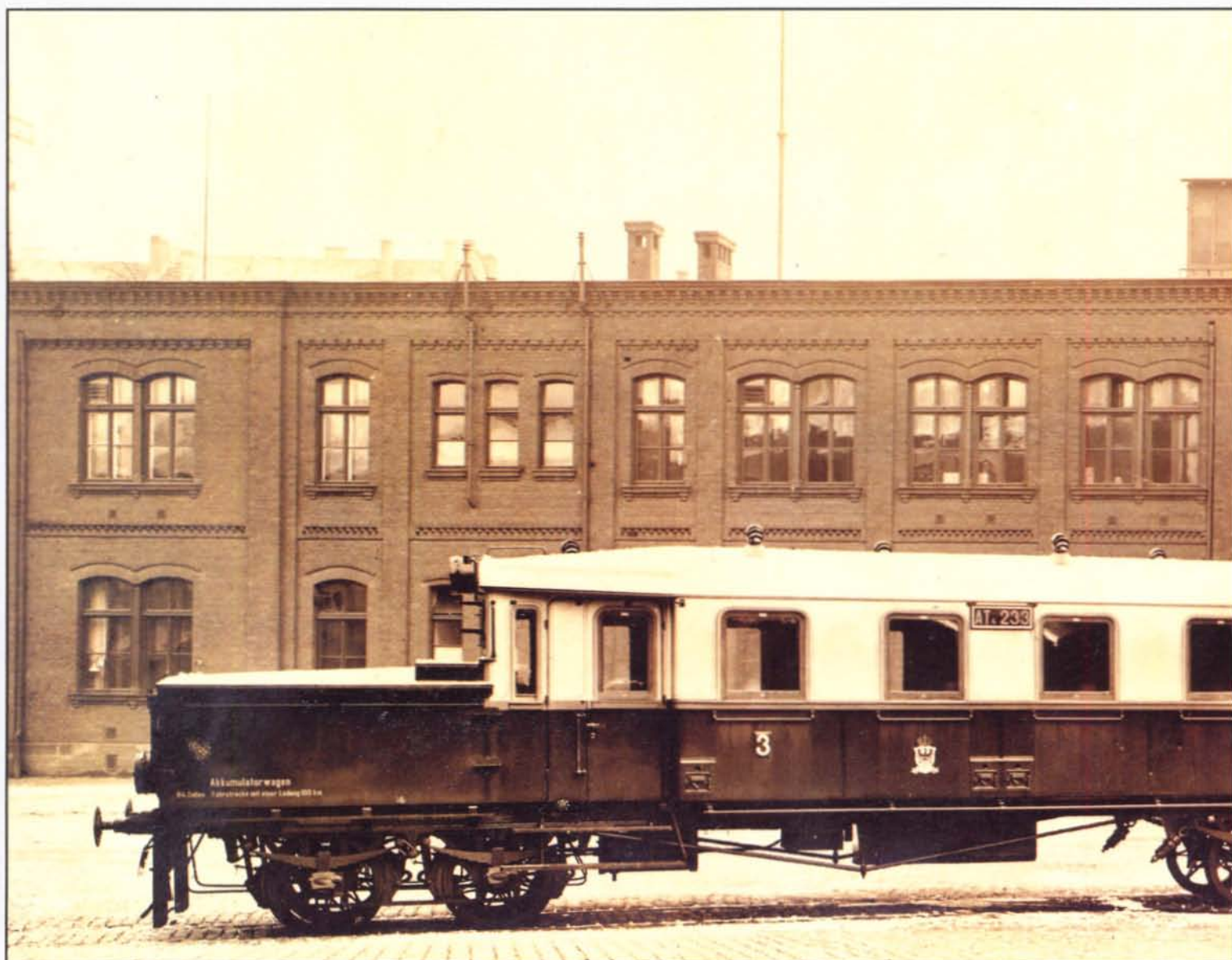
Bild 1: Der AT 233/234 war einer der wenigen Wittfeld-Akkutriebwagen mit Nebenschlußmotor. Das Werkfoto zeigt ihn im Originalzustand bei seiner Ablieferung an die KPEV im Jahre 1912. 1928 wurde er durch den Einbau von zwei Hauptstrommotoren den Akkutriebwagen üblicher Bauart angepaßt. Am 14. März 1945 zerstörten ihn alliierte Bomber in Hildesheim. Foto: Sammlung Dr. Scheingraber
