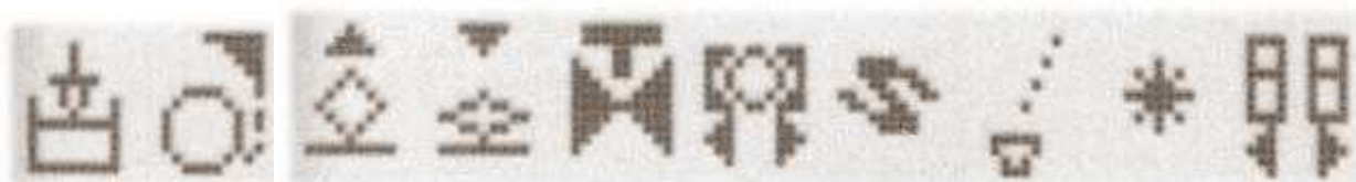
Компрессор Песок пантограф вверх/низ кран отпуск тормозов сцепление парогенератор отопление двери открываются
